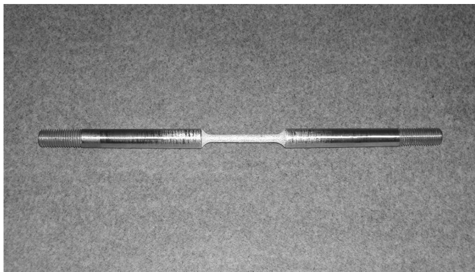
FIGURA 4.4 – Aspecto do corpo de prova utilizado nos ensaios de corrosão sob tensão conforme a norma NACE TM 0177-90.
