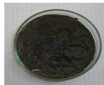
Figura 2: Amostra seca em base úmida na temperatura de 60°C.
