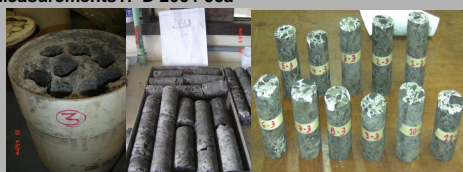
Figura 2 Corpos de prova usados no teste triaxial.
