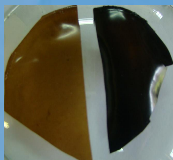
Figura 1: Membrana antes (esquerda) e após (direita) tratamento térmico.
