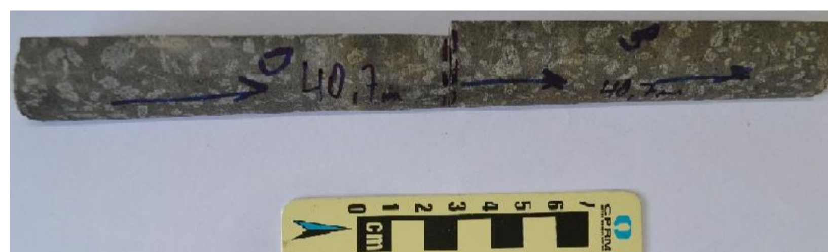
Fig. 3 – Testemunho de sondagem de 40,7 m de profundidade.
