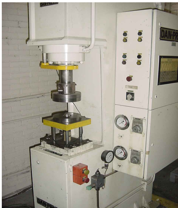
Fig. 3.5 –Prensa instrumentada do LdTM da UFRGS para ensaio de estampagem.
