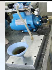
Fig. 5 - Confeção de peça de compósito utilizando molde fechado e bomba de vácuo.
