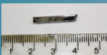
Fig.3 - Amostra de pino já lixada e polida para análise de MEV/EDS.
