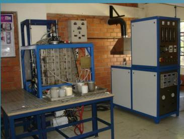
Fig.1 - Forno Elétrico Resistivo e sistema de controle (LaSid-UFRGS).
