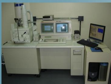
Fig.2 - Microscópio Eletrônico de Varredura com EDS acoplado (CME-UFRGS).
