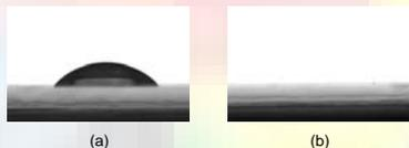
Figura 3 (a) Ângulo de contato da gota de água sob a superfície de vidro sem filme. (b) Ângulo de contato da gota de água sob o filme.
