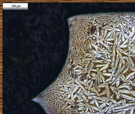
Figura 4. Metalografia da liga de nitinol 3M. Se observa grande quantidade de agulhas de martensita.
