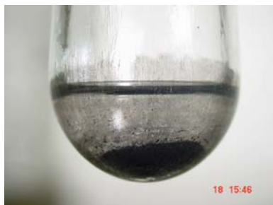
Figura 49. Redução do complexo [Ir(cod)Cl]_2 em diclorometano, sem a presença de líquido iônico. É possível visualizar, ao fundo do reator, o aglomerado formado por irídio metálico.
