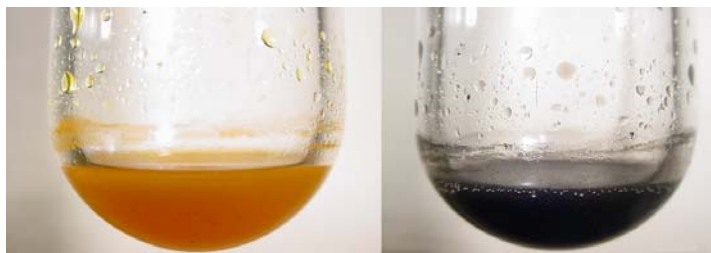
Figura 48. Precursor catalítico [Ir(cod)Cl]_2 imobilizado no líquido iônico BMI.PF 6 (esquerda). Nanopartículas de Ir(0) obtidas após a redução do precursor catalítico sob 5 atm de H 2 e 75 °C (direita).
