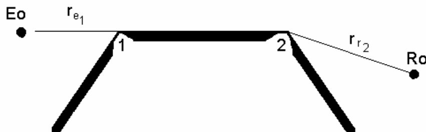
Figura 2: Caso limite em que o emissor encontra-se no contorno da zona de sombra de uma difração de apenas uma única borda.
