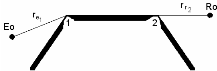
Figura 3: Caso limite em que o receptor encontra-se no contorno da zona de sombra de uma difração de apenas uma única borda.
