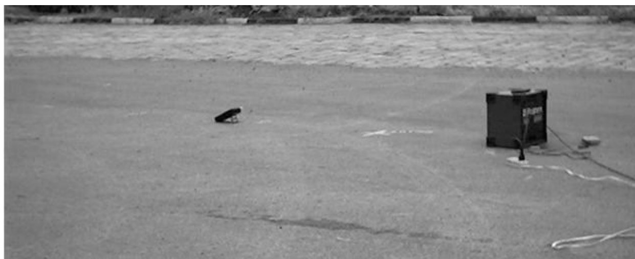
Figura 7.5: Receptor e emissor posicionados antes da inserção da barreira.
