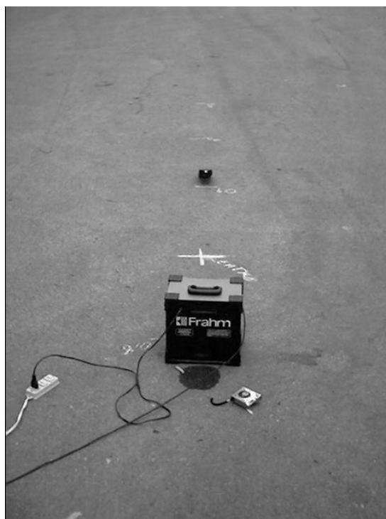
Figura 7.3: Local da medição, emissor e receptor alinhados com o ponto central mostrado por uma cruz.
