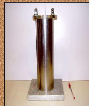
Molde Cilíndrico para o ensaio de Lixiviação em Coluna
