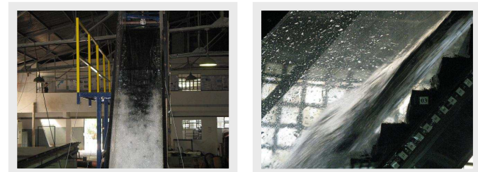
Início da aeração no degrau do modelo – LOH/IPH - UFRGS
