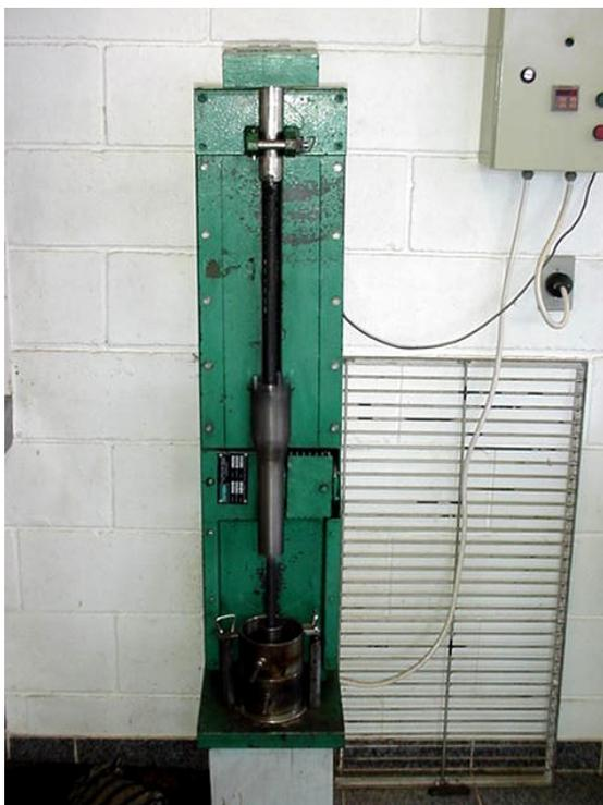
Figura 3.19- Compactação dos corpos-de-prova
