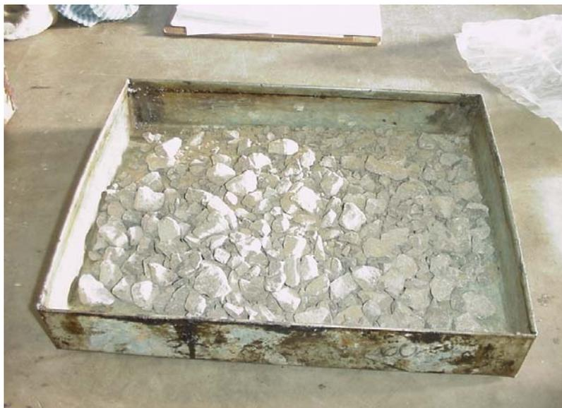
Figura 3.16- Mistura de agregados secos
