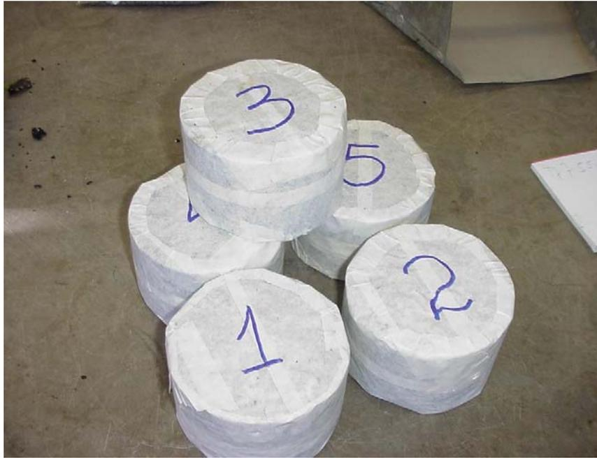
Figura 3.21- Corpos-de-prova com fita
