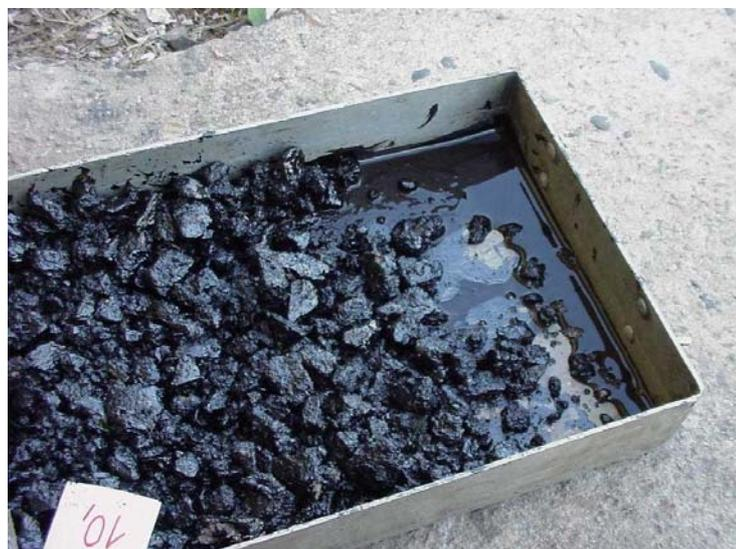
Figura 3.18- Ruptura da Emulsão Asfáltica
