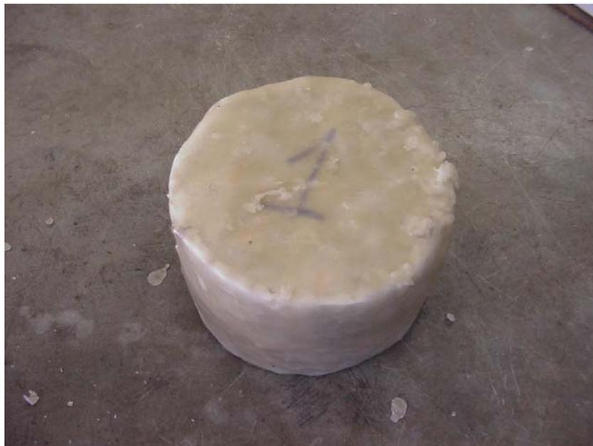
Figura 3.22- Corpo-de-prova com fita e parafina
