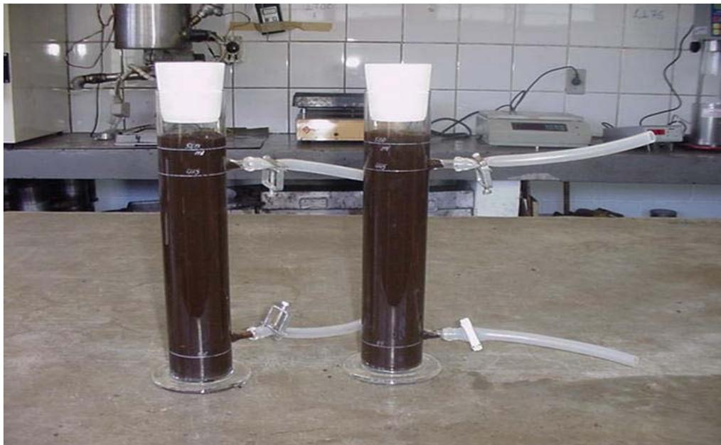
Figura 3.2- Ensaio de Sedimentação
