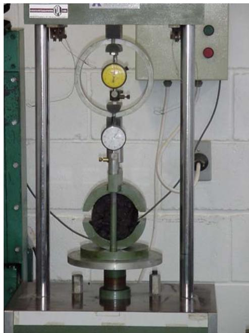
Figura 3.23- Ensaio de Estabilidade e Fluência Marshall
