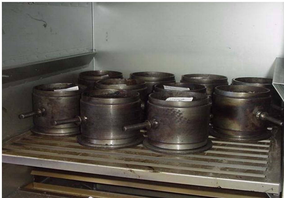
Figura 3.20- Corpos-de-prova durante cura na estufa
