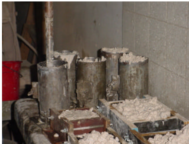
Figura 4.12 Adensamento do concreto e fôrmas utilizadas
