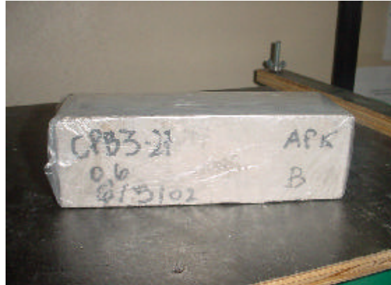
Figura 4.6 Corpo-de-prova embalado para homogeneização
