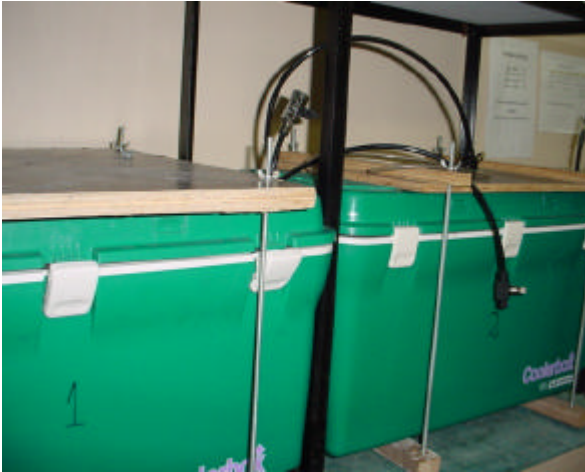
Figura 4.2 Câmaras de carbonatação saturadas de CO 2
