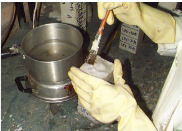
Figura 4.7 Corpo-de-prova sendo aplicado parafina
