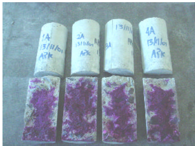
Figura 4.4 Aspecto dos corpos-de-prova cilíndricos após carbonatação acelerada
