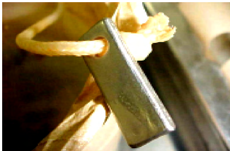
Figura 21: Corpo de prova aço inoxidável AISI 304. (~2,5 X)
