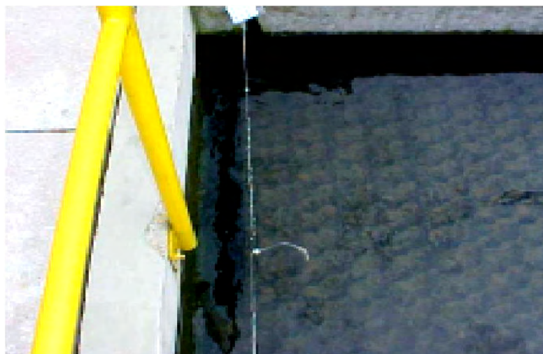
Figura 23: Corpos de prova imersos no tratamento d'água potável.
