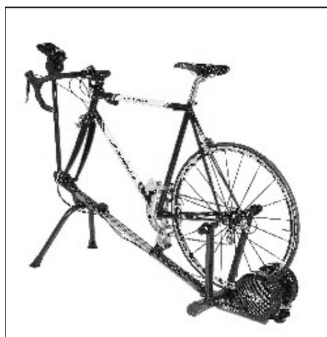
**Figura 3.1** – Ciclossimulador magnético Cateye Cs1000 com a bicicleta acoplada.
