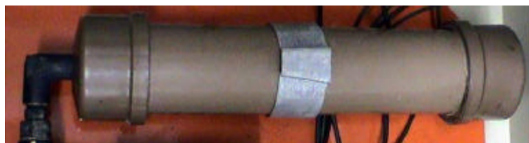
Figura 3.9 – Cilindro em PVC para armazenagem do gás.
