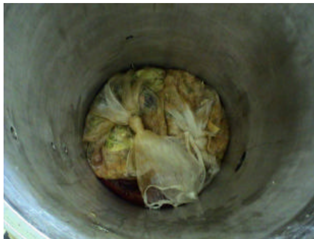
Figura 3.19 – Resíduo acondicionado em sacos plásticos de rafia e colocados no fundo do biorreator.
