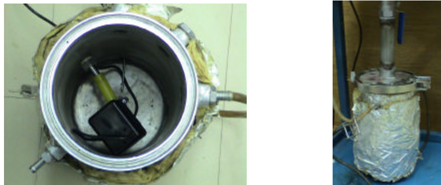
Figura 3.24 – Moto Bomba Better 650, acoplada no interior do biorreator.
