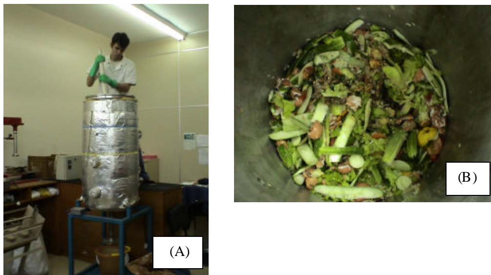
Figura 3.20 – (A) resíduo em processo de compactação e (B) resíduo compactado.
