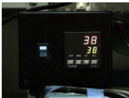
Figura 3.5 – Controlador Universal Modelo N1100.
