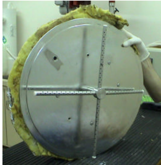
Figura 3.3 – Tampa de aço inox com dispersor de chorume.
