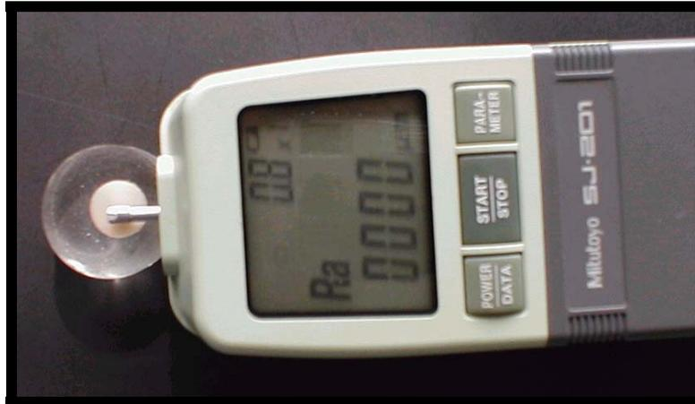
**FIGURA 3 – Corpo de prova de AllCeram polido, embutido em resina acrílica e posicionado para leitura com o rugosímetro.**
