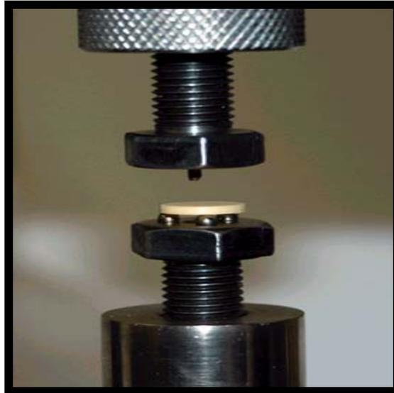
**FIGURA 2 – Corpo de prova (Procera) posicionado na matriz utilizada para o ensaio de resistência flexural.**
