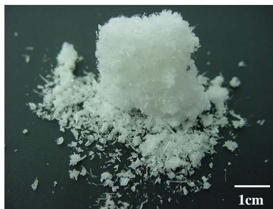
Figura 6.5 - Gel parcialmente desidratado obtido através da metodologia de secagem 2, para a formulação E, sem PVA.
