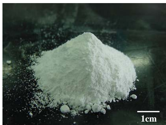
Figura 6.1 - Pó de alumina, sem calcinação, obtido através do método sol-gel nas formulações B e D, utilizando a metodologia de secagem 1.
