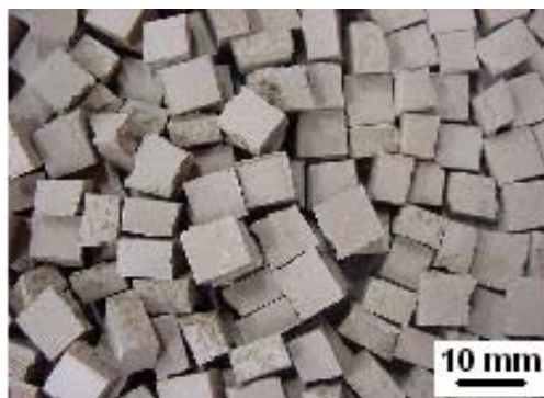
Figura 5.12- Amostras dos corpos de prova para ensaio de lixiviação e solubilização.
