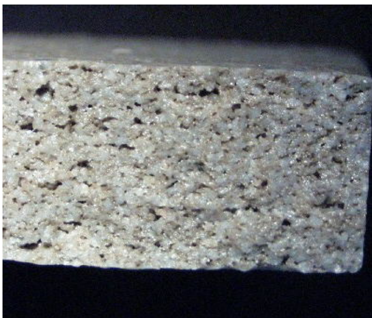
Figura 6.6 – Amostra AT queimada a 1100°C: bolhas internas possivelmente resultantes do processo de fervura de silicatos.
