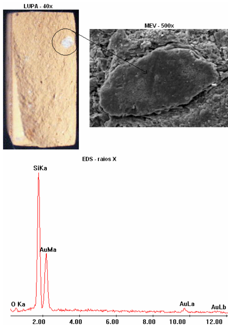
Figura 6.12 – Fractografia do corpo cerâmico da amostra BI queimada a 1100oC. O círculo realça a presença de um grão grosseiro de quartzo, junto à superfície do corpo cerâmico, provável controlador da resistência mecânica do corpo cerâmico.
