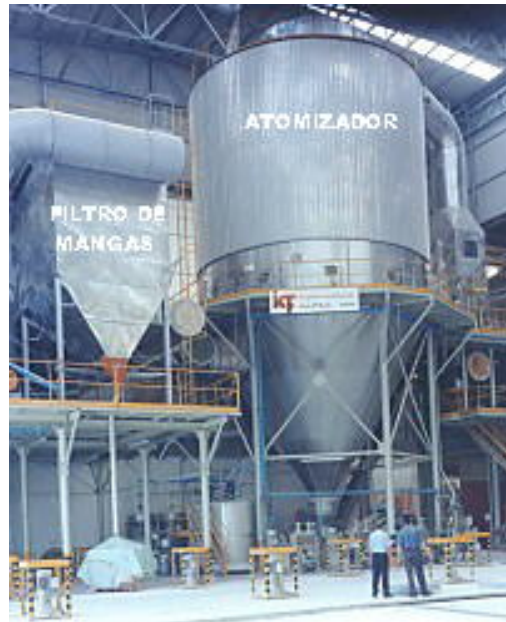
Figura 4.22 – Foto de um atomizador e filtro de mangas (ICF, 2003).
