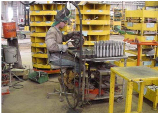
Figura 1 - Posto de soldagem do tipo Bancada
