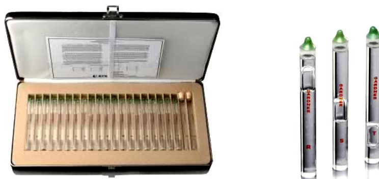
Figura 19. Tubos padrão para determinação da viscosidade Gardner 58
