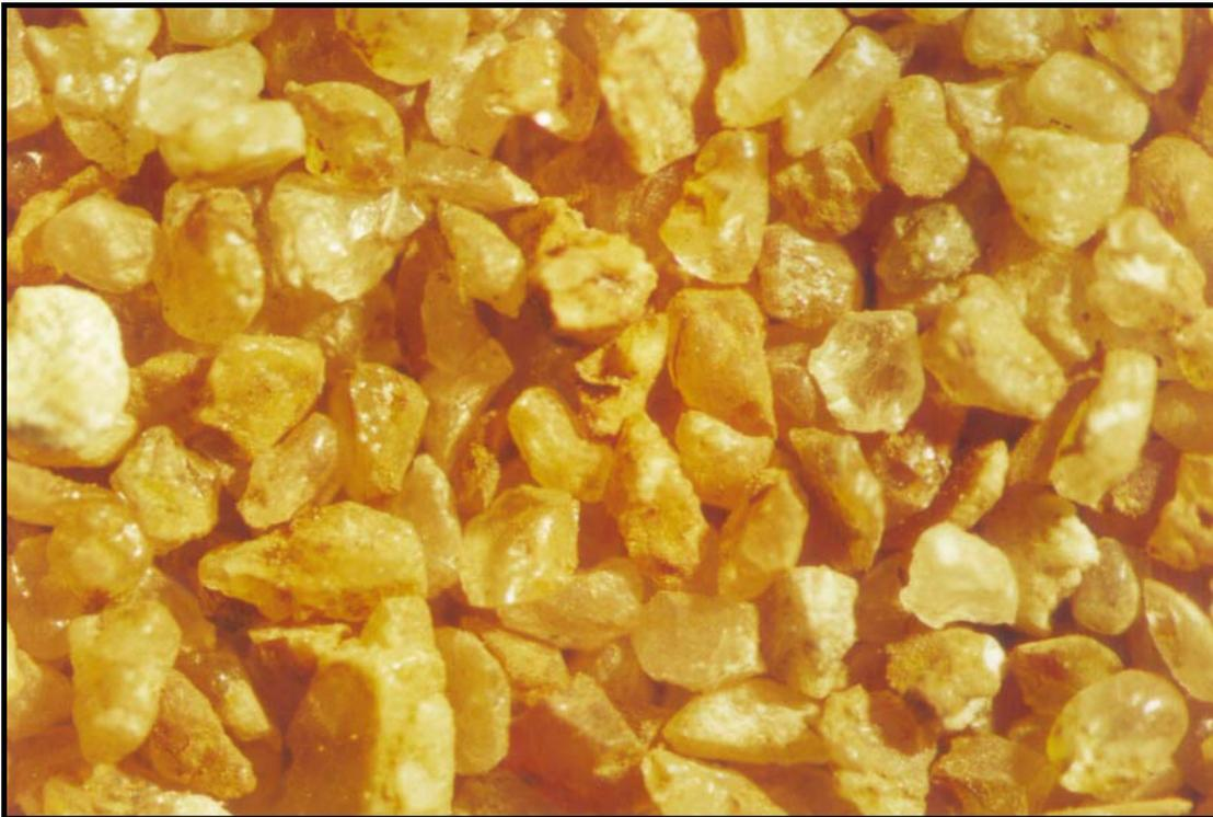
Figura 12 – Fração mineral na granulometria + 0,42 mm observada em lupa (20X)
