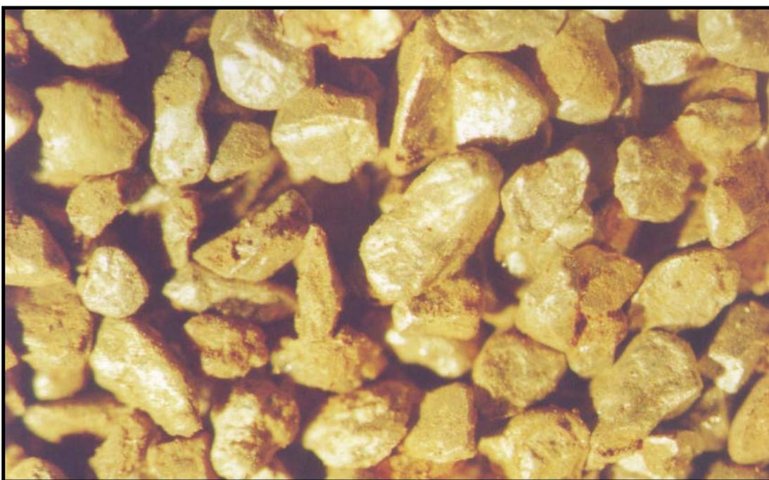
Figura 11 – Granalha na granulometria + 0,42 mm observada em lupa (20X)
