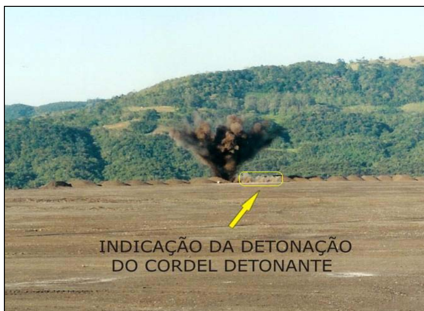
Figura 4.14 Teste de detonação em tubo de aço onde pode ser visualizada a iniciação do cordel pelo final da carga de ANFO colocada no tubo.
