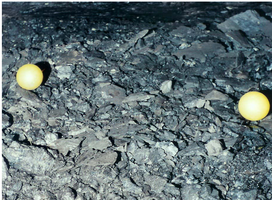
Figura 3.5 Segunda e definitiva escala de referência (bolas plásticas) utilizada na análise de imagens.
