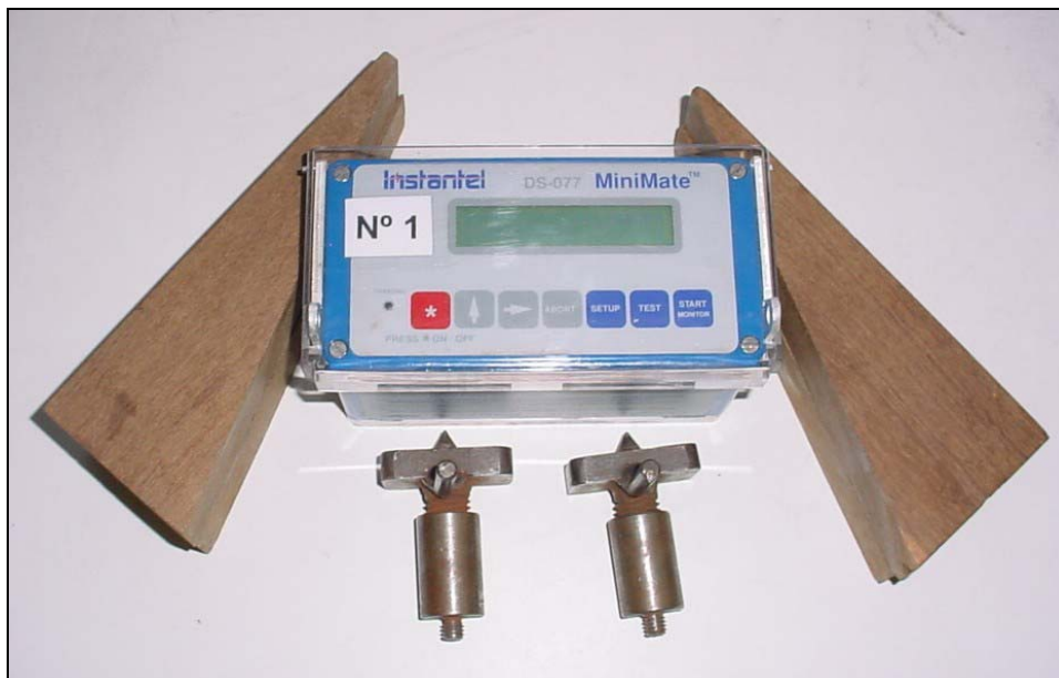
Figura 3.6 Sismógrafo Instantel Minimate™ DS-077 empregado no monitoramento das vibrações.
