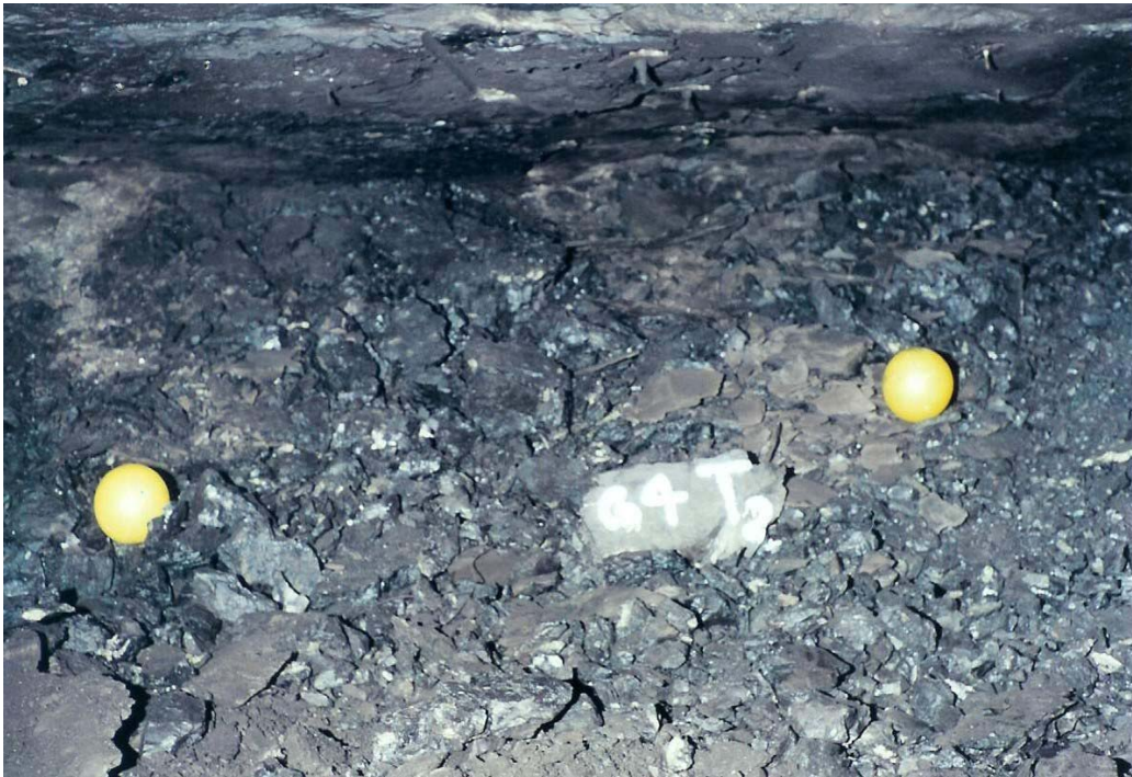
Figura 3.31 Imagem nº 1 do desmonte referente ao evento 18 utilizando bolas como escalas de referência.
