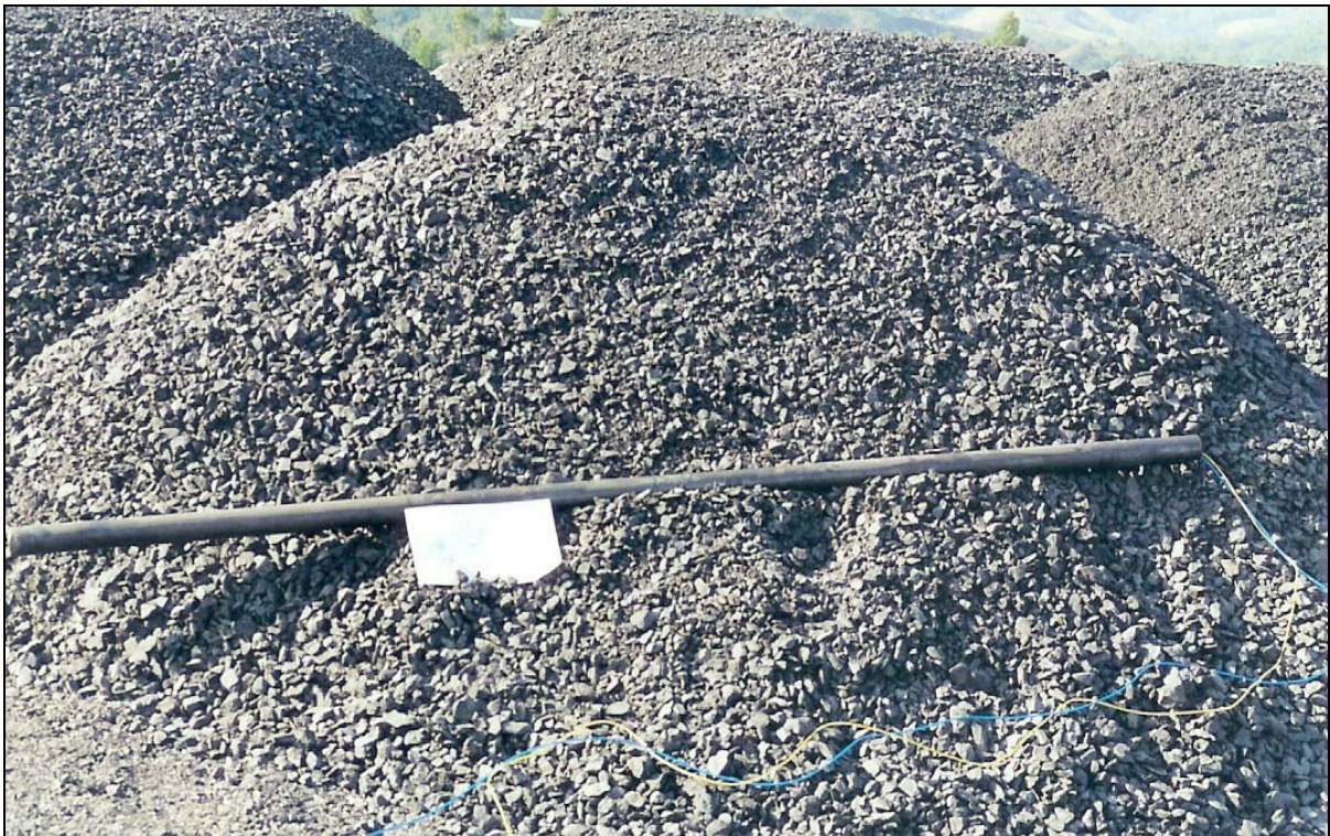
Figura 4.13 Visualização de um tubo carregado com ANFO. A linha azul corresponde ao cordel detonante empregado como medida indireta de velocidade de detonação e a linha amarela refere-se ao tubo de choque do sistema de iniciação.
