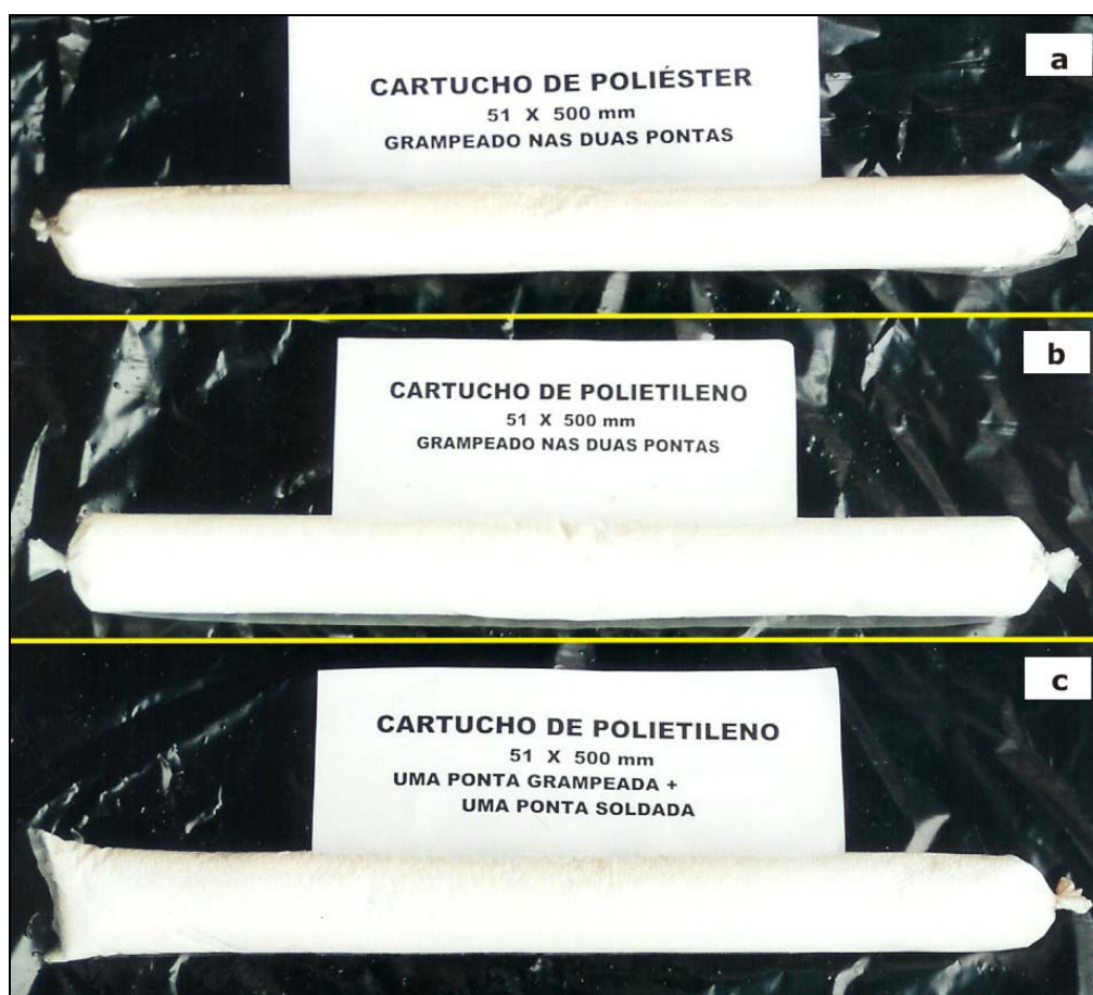
Figura 4.18 Configurações de cartuchos testados para acondicionar o ANFO.
