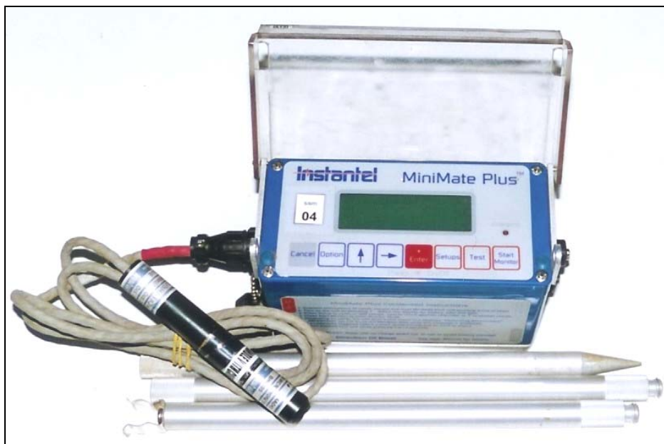
Figura 5.1 Sismógrafo Instantel Minimate™ Plus empregado nos ensaios.
