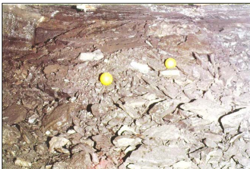
Figura 4.23 Fragmentação obtida em desmonte com ANFO.
