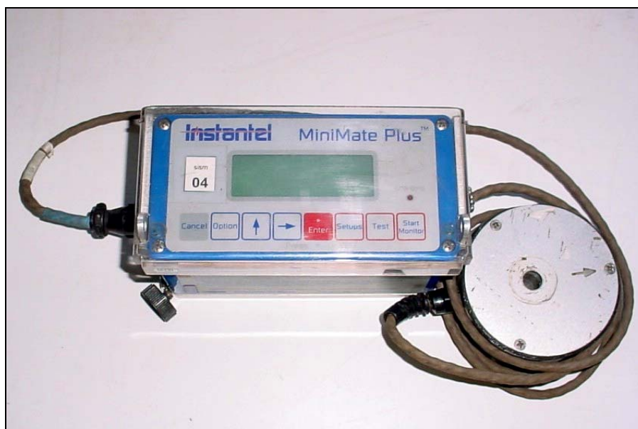
Figura 4.25 Sismógrafo Instantel Minimate™ Plus empregado no monitoramento dos testes de ANFO.
