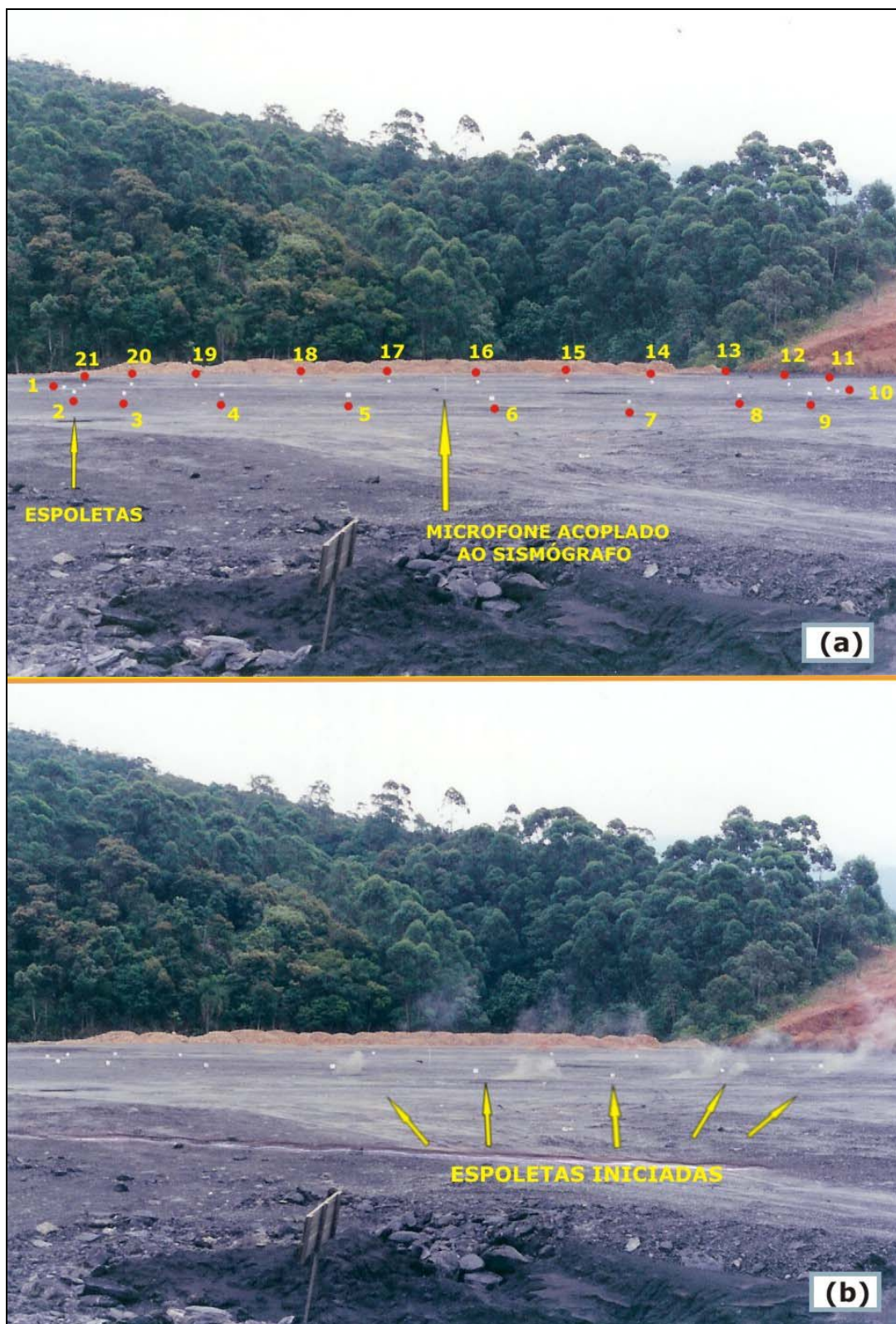
Figura 5.3 Ensaio em campo. Em (a) pode ser visualizado um teste montado e em (b) o mesmo teste em execução.
