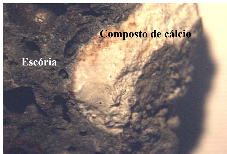
Figura 11: Imagem via lupa da amostra de escória EAE 6, com seis meses de exposição ao ambiente. Aumento de 12x.
