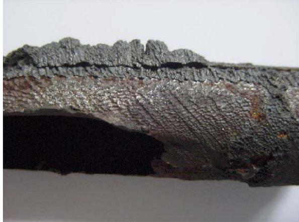
*Figura 4: Cano de aço carbono em trocador de calor – corrosão generalizada.*
