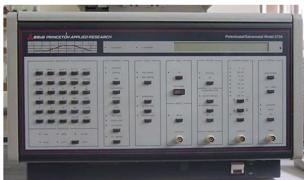
Figura 19: Galvanostato/potenciostato modelo EG&G PAR 273A usado em testes de voltametria cíclica.
