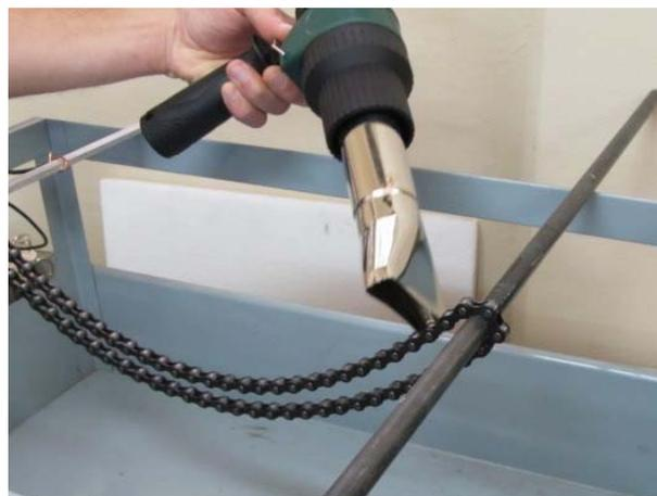
Figura 4.6 - Aquecimento da corrente para aplicação de aditivo.
