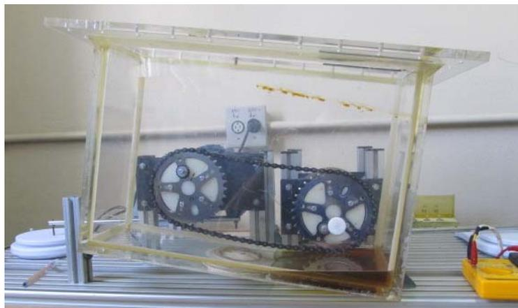
Figura 4.3 - Lubrificação por banho de óleo.
