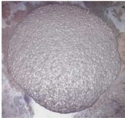
Figura 6: CAA sem segregação (MBT, 2004)
