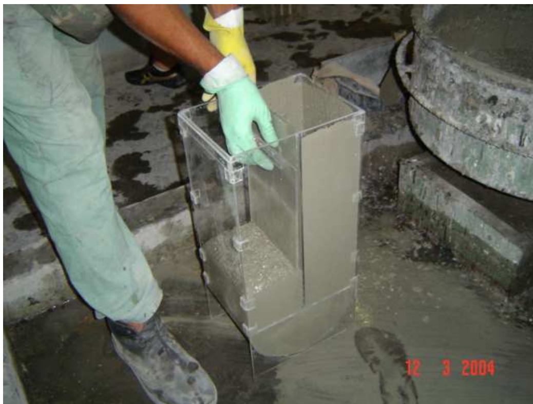
Figura 15: ensaio do u-box em andamento
