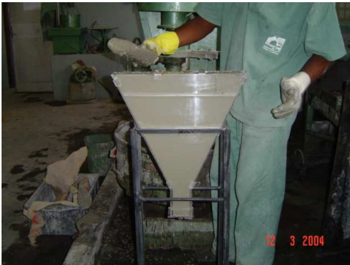
Figura 11: V-Funnel sendo utilizado
