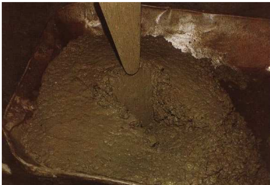
Figura 27: aspecto do concreto com teor ideal de argamassa seca (fonte: HELENE e TERZIAN, 1992, p.257)
