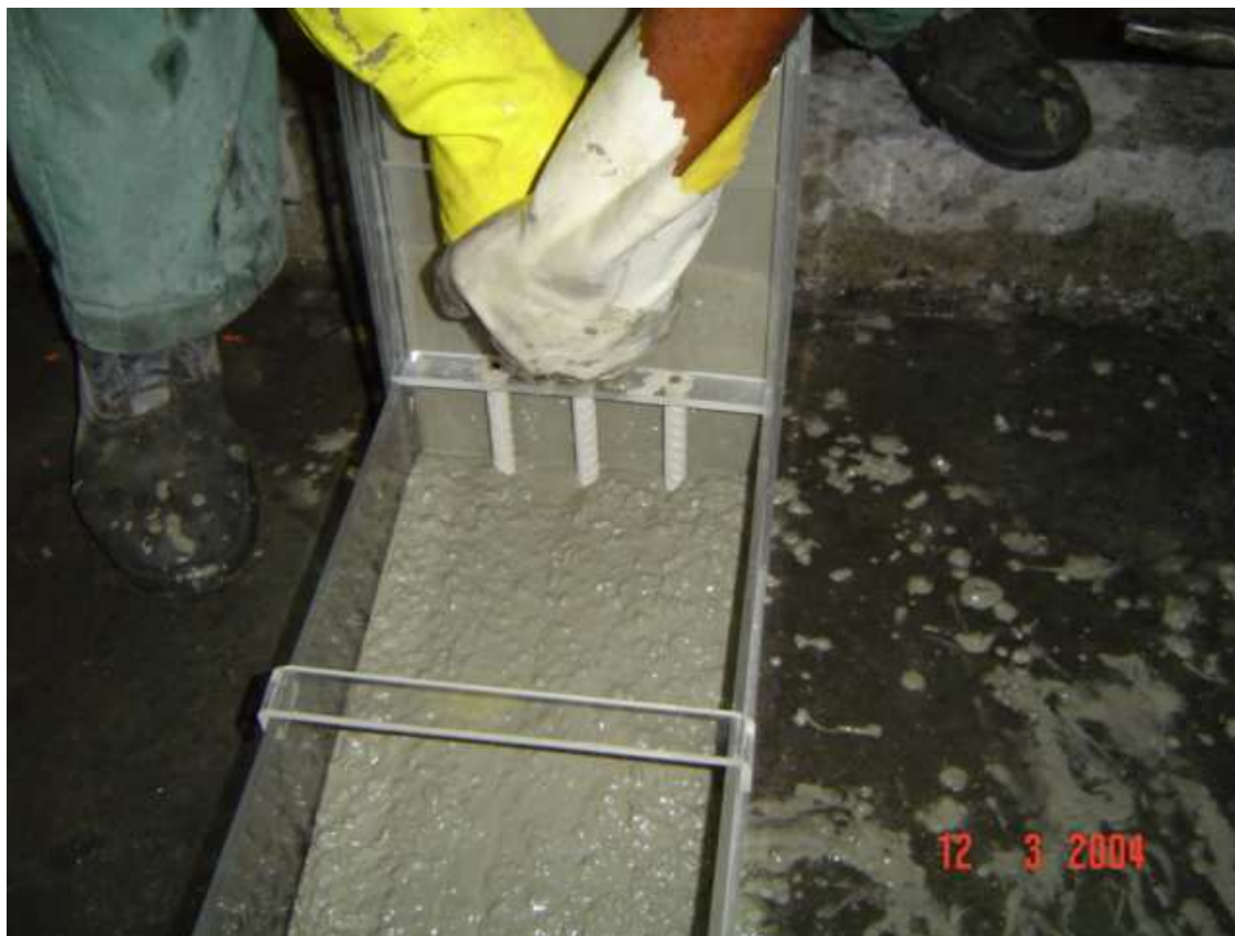
Figura 13: ensaio do l -box em andamento
