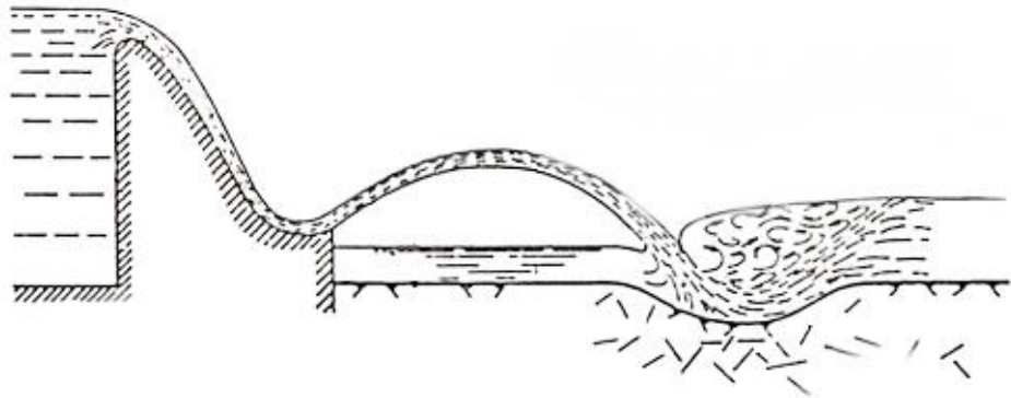
Figura 12 – Representação esquemática de um vertedouro com salto de esqui
