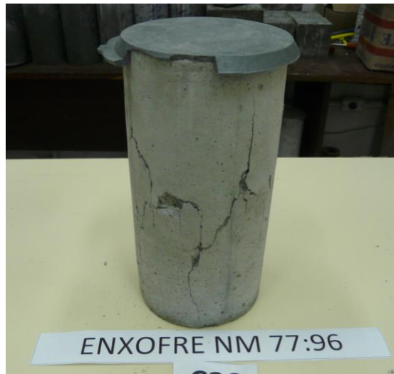
Figura 46 – Ruptura de corpo-de-prova capeado com enxofre segundo a NM 77
