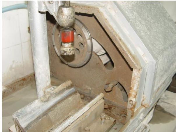
Figura 41 – Disco diamantado da retífica horizontal
