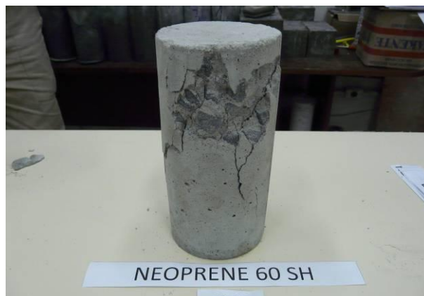
Figura 51 – Ruptura de corpo-de-prova ensaiado com neoprene dureza 60 shore
