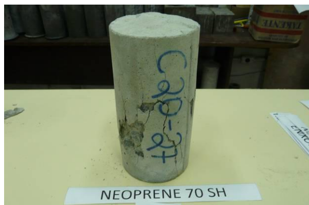
Figura 52 – Ruptura de corpo-de-prova ensaiado com neoprene dureza 70 shore
