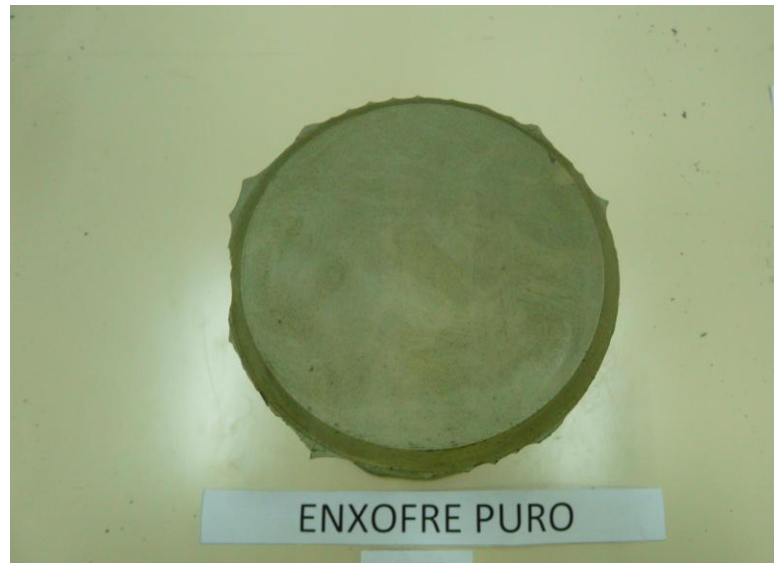
Figura 28 – Aparência de face preparada com enxofre puro derretido
