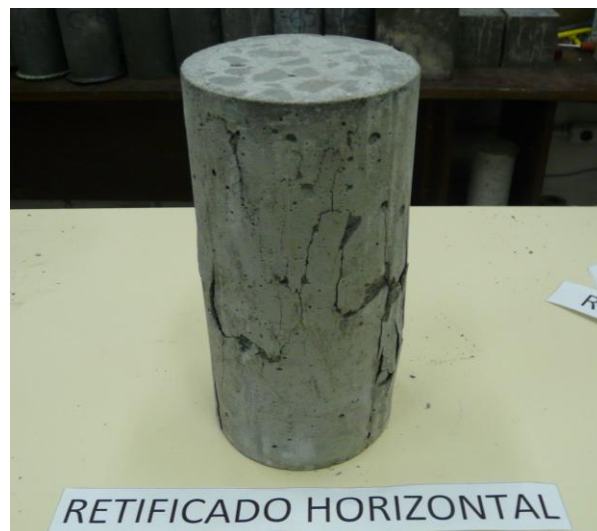
Figura 49 – Ruptura de corpo-de-prova retificado com retífica horizontal
