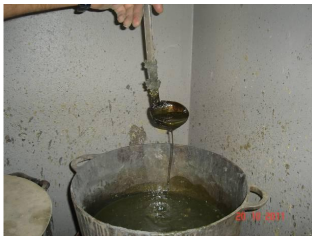
Figura 25 – Consistência do enxofre puro derretido
