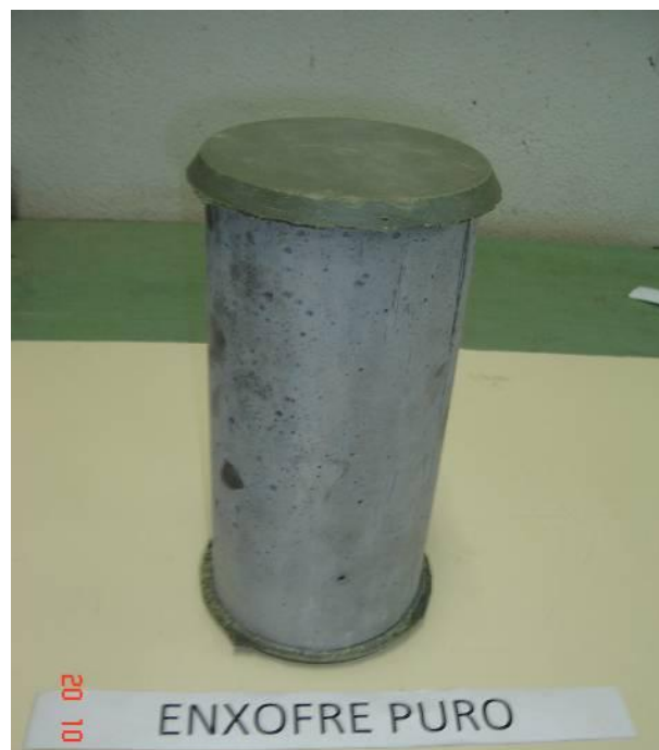
Figura 29 – Corpo-de-prova preparado com enxofre puro pronto para ensaio
