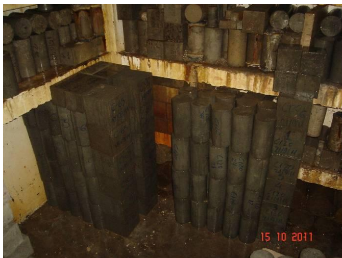
Figura 14 – Corpos-de-prova acondicionados em câmara úmida
