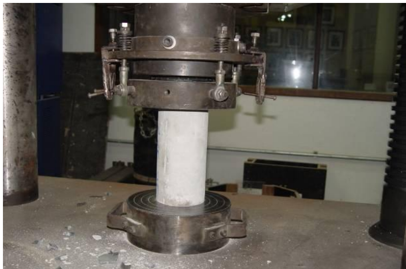
Figura 47 – Corpo-de-prova retificado sendo ensaiado
