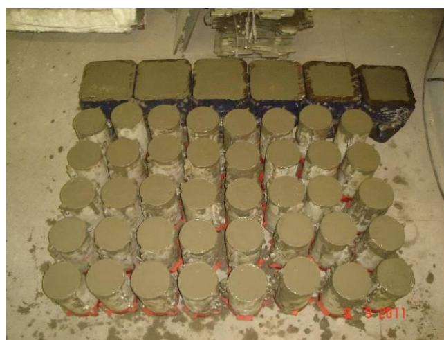
Figura 12 – Corpos-de-prova recém moldados
