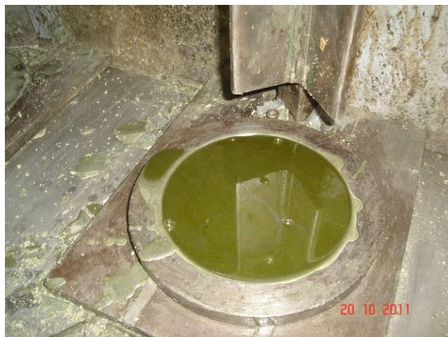
Figura 26 – Capeador pronto para receber o corpo-de-prova
