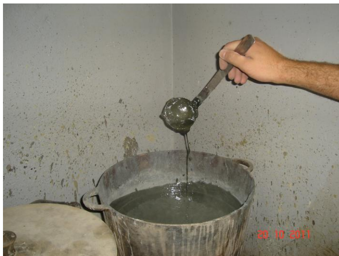
Figura 19 – Consistência da mistura de enxofre derretido segundo a NM 77
