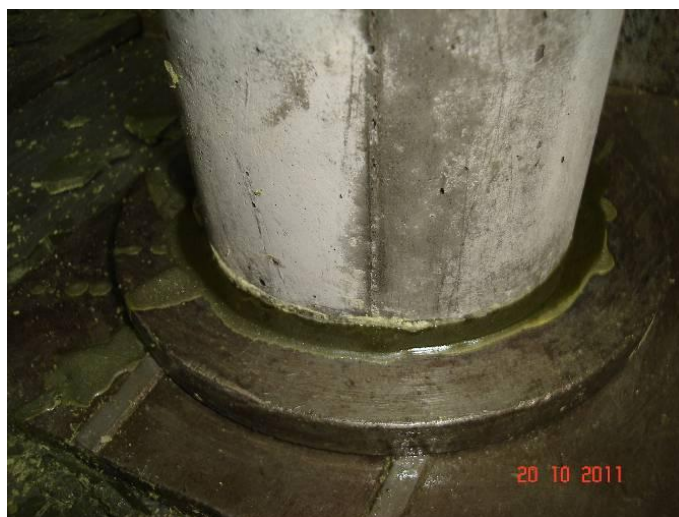
Figura 27 – Enxofre puro derretido envolvendo todo corpo-de-prova
