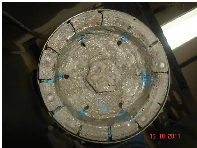
Figura 36 – Disco diamantado da retífica vertical
