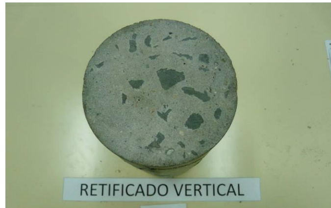
Figura 37 – Aparência da superfície retificada
