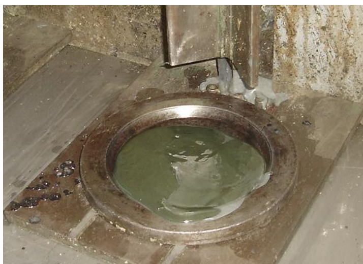
Figura 20 – Mistura pronta no capeador
