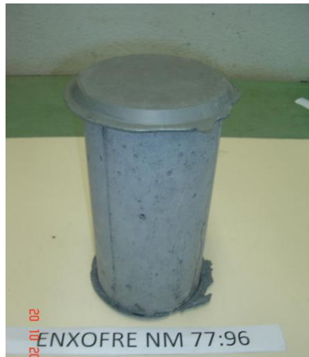
Figura 24 – Corpo-de-prova preparado com mistura de enxofre segundo a NM 77
