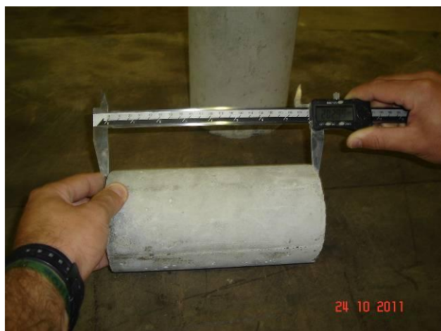
Figura 16 – Corpo-de-prova sendo medido
