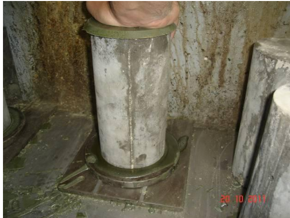
Figura 21 – Corpo-de-prova fixado pelo operador
