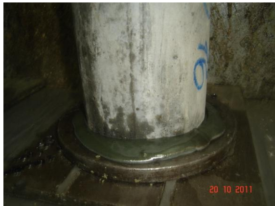
Figura 22 – Mistura envolvendo completamente a face do corpo-de-prova
