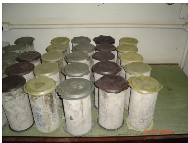
Figura 2 – Corpos-de-prova capeados com enxofre
