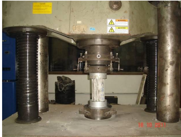
Figura 50 – Corpo-de-prova com disco de neoprene confinado sendo ensaiado
