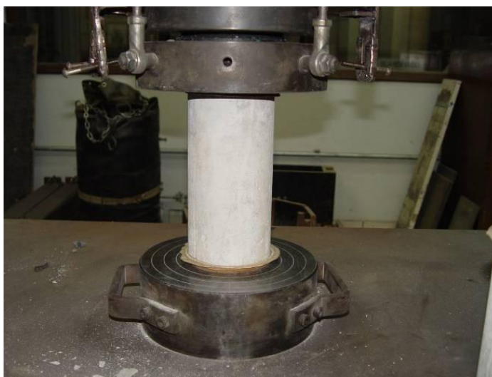
Figura 44 – Corpo-de-prova capeado com enxofre sendo ensaiado
