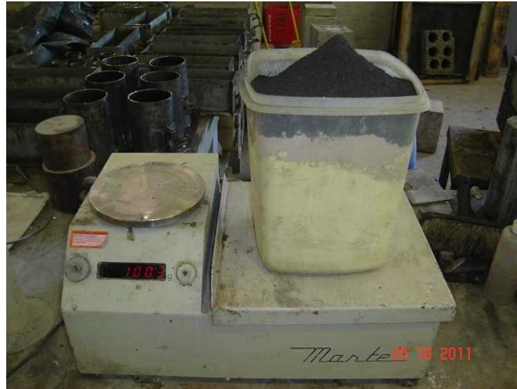
Figura 17 – Pesagem dos materiais da mistura
