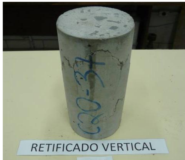
Figura 48 – Ruptura de corpo-de-prova retificado com retífica vertical
