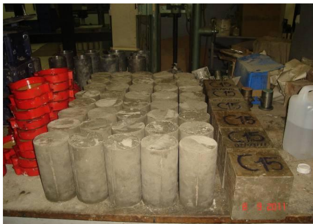
Figura 13 – Corpos-de-prova desmoldados após 24 horas
