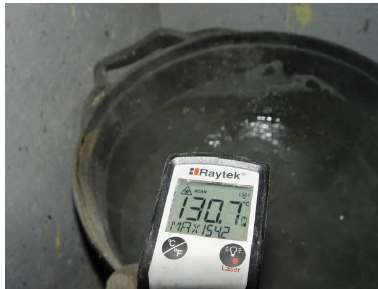
Figura 18 – Controle da temperatura do enxofre derretido
