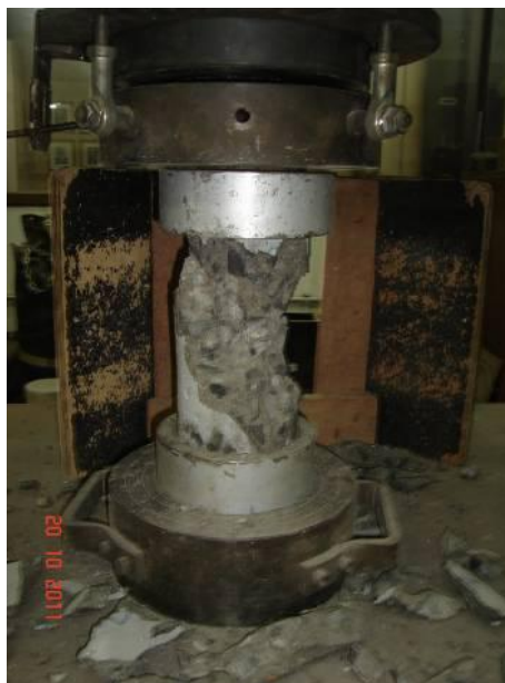
Figura 53 – Ruptura Brusca com discos de neoprene
