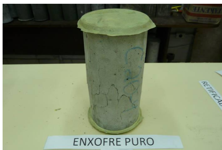
Figura 45 – Ruptura de corpo-de-prova capeado com enxofre puro
