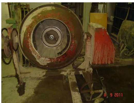
Figura 9 – Betoneira de eixo inclinado
