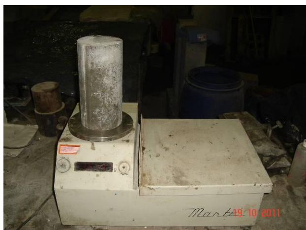
Figura 15 – Pesagem dos corpos-de-prova
