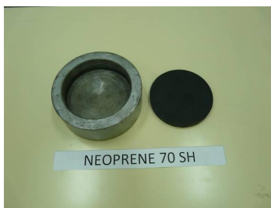
Figura 31 – Disco de neoprene de dureza 70 shore e pratos de confinamento
