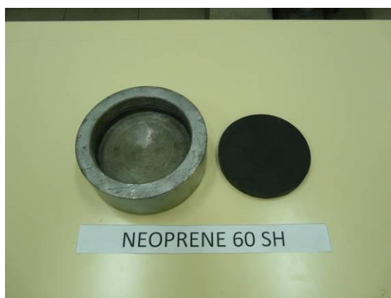
Figura 30 – Disco de neoprene de dureza 60 shore e pratos de confinamento
