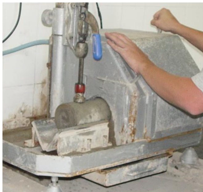
Figura 40 – Corpo-de-prova sendo retificado com retífica horizontal
