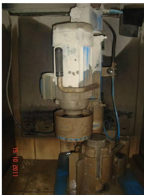
Figura 34 – Retífica vertical pneumática utilizada
