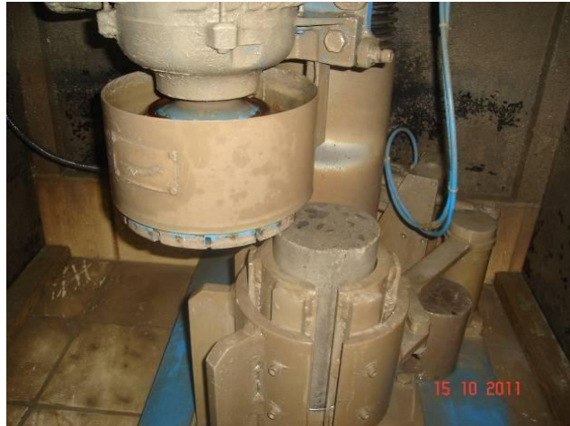
Figura 35 – Corpo-de-prova sendo retificado com retífica vertical
