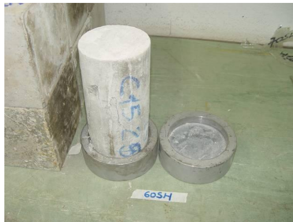
Figura 33 – Corpo-de-prova pronto para ser ensaiado com discos de neoprene
