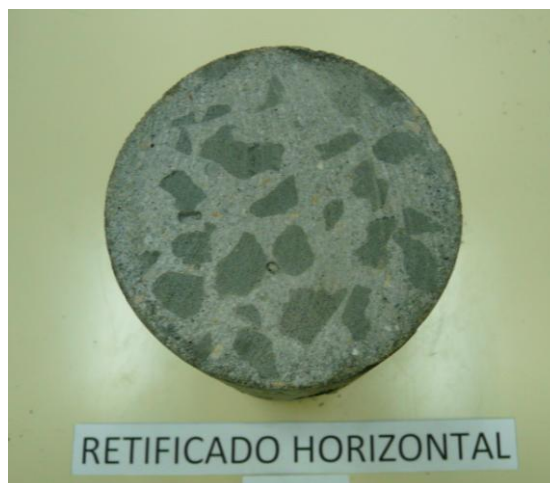
Figura 42 – Aparência da superfície preparada com retífica horizontal
