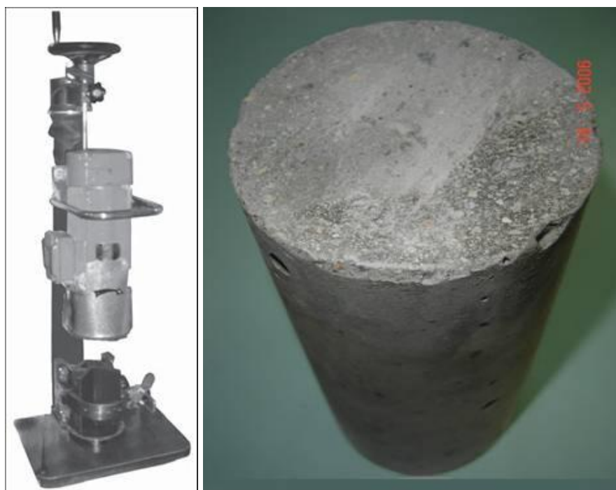
Figura 6 – Retificadora vertical e corpo-de-prova retificado
