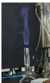
FIGURA 5.1 – Descolamento de chama no bico de Bunsen (vazão de metano de 350L/h).
