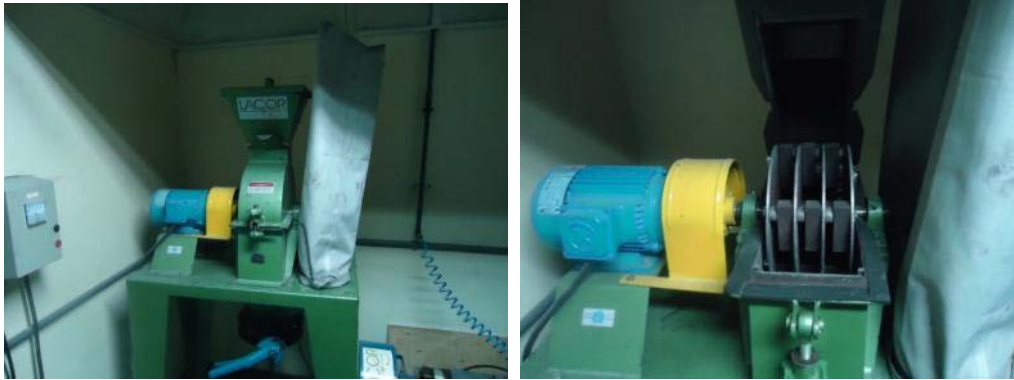
Figura 4.1 – Britador de martelos fechado (Esquerda) e aberto (Direita).
