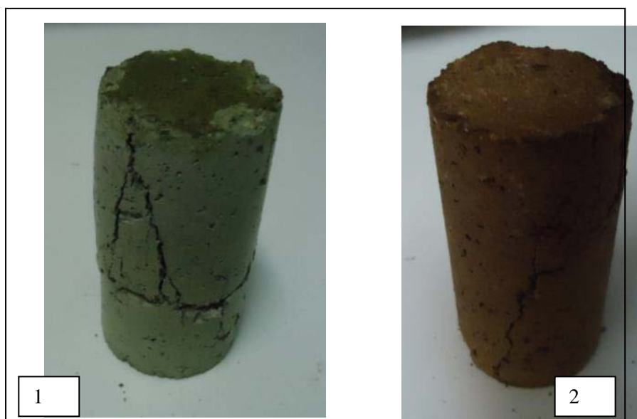
Figura 5.15 – Corpos-de-prova fraturados (1 – Calcinado sem resíduo; 2 – Sinterizado com Resíduo)
