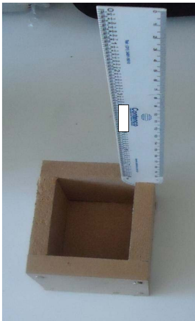
Figura 4.3 – Dispositivo utilizado para o ensaio de plasticidade.
