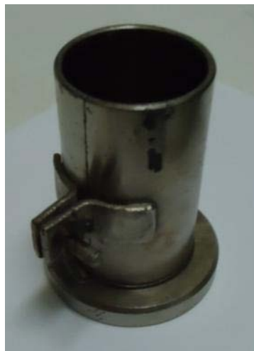
Figura 4.2 – Molde de aço utilizado para fabricação dos corpos de prova.
