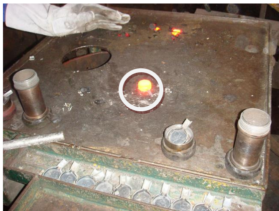
Figura 23. Amostra retirada através do amostrador no Forno-Panela
