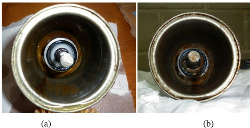
Figura 5.18 – Copos dos filtros do combustível: após a primeira etapa dos ensaios e (b) após a segunda etapa dos ensaios
