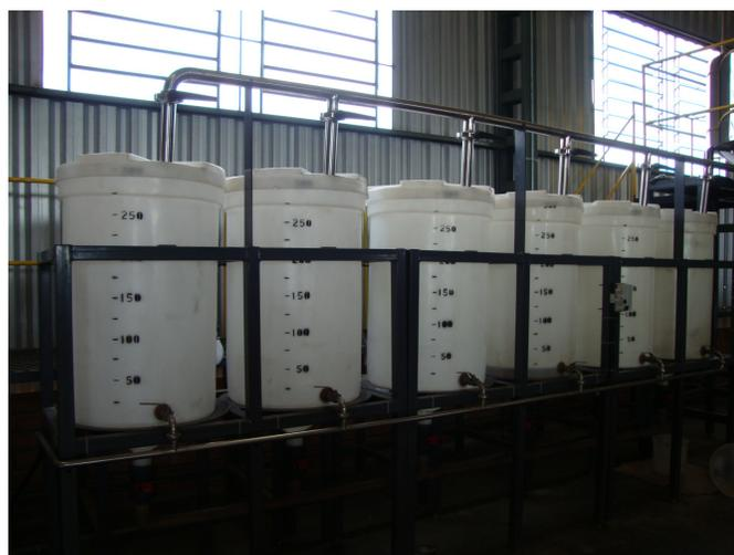
Figura 4.7 – Tanques usados para decantação da glicerina após a transesterificação do óleo
