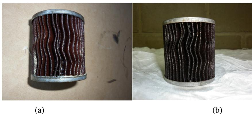
Figura 5.17 - Filtros de combustível: (a) após a primeira etapa dos ensaios e (b) após a segunda etapa dos ensaios
