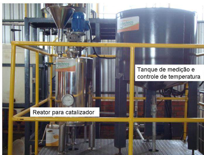
Figura 4.5 – Reator para dissolução do catalisador e tanque de medição e controle de temperatura do OGR
