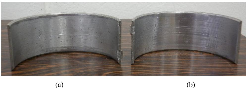
Figura 5.4 – Condição dos mancais: (a) usado na primeira etapa dos ensaios e (b) usado na segunda etapa dos ensaios
