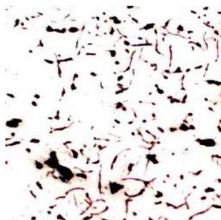
Figura 5.14 – Matriz do 1º anel de compressão (novo) fabricado em ferro fundido lamelar (ampliação de 100 vezes)
