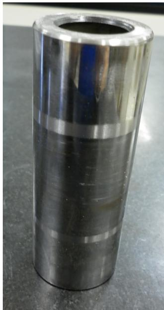
Figura D.1.3 – Aspecto superficial do pino da biela ao final dos ensaios com biodiesel
