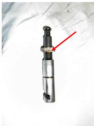
Figura 5.10b – Êmbolo da bomba de combustível usada na segunda etapa dos ensaios
