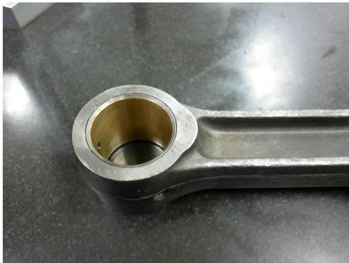
Figura D.1.5 – Aspecto da bucha da cabeça da biela ao final dos ensaios com biodiesel
