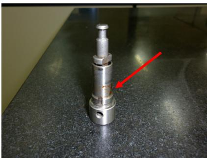
Figura 5.10a – Êmbolo da bomba de combustível usada na primeira etapa dos ensaios
