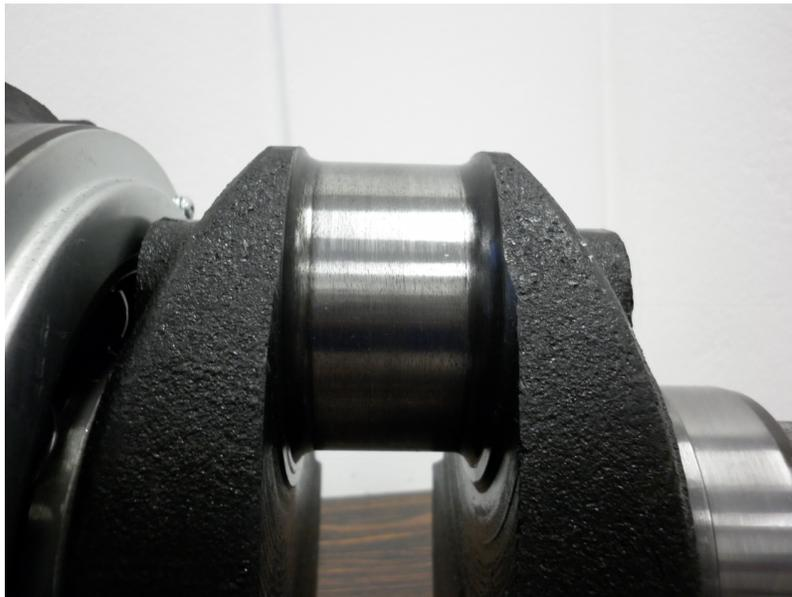
Figura D.1.1 – Aspecto superficial da árvore de manivelas ao final dos ensaios com biodiesel
