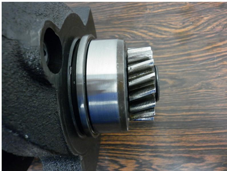
Figura D.1.2 – Aspecto superficial do mancal e da engrenagem de transmissão da árvore de manivelas ao final dos ensaios com biodiesel
