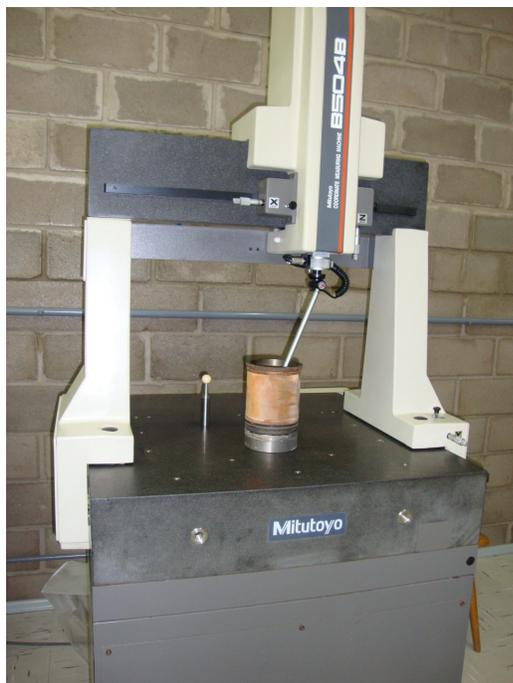
Figura 4.9 – Máquina de medição tridimensional Mitutoyo, usada na análise dimensional nos componentes do motor
