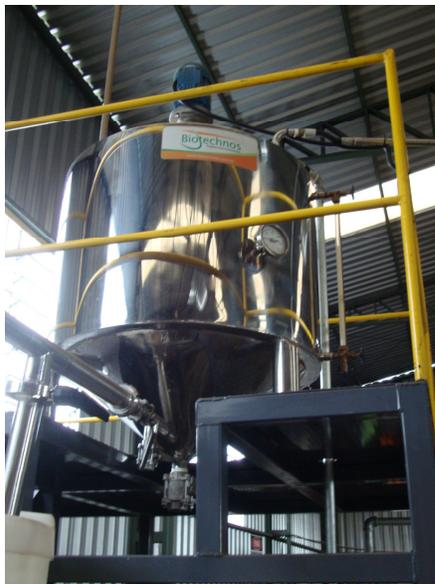
Figura 4.6 – Reator para a transesterificação do óleo e produção do biodiesel usado durante as pesquisas
