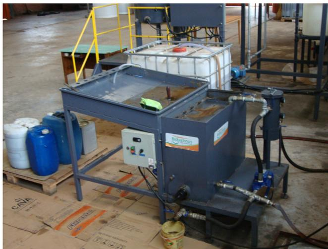
Figura 4.4 – Filtragem do óleo antes do início do processo de produção de biodiesel
