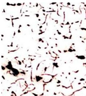
Figura 5.16 – Face externa do 1º anel de compressão usado na segunda etapa dos ensaios (ampliação de 100 vezes)
