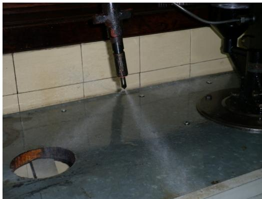
Figura 5.9 – Realização de ensaio em bancada para verificação da pressão de injeção do combustível
