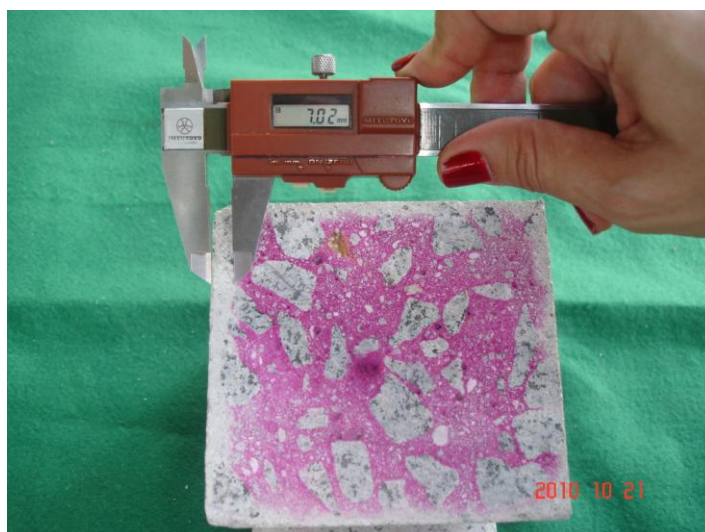
Figura 47 – Determinação da profundidade de carbonatação com paquímetro digital, após aplicação do indicador de fenolftaleína no concreto.
