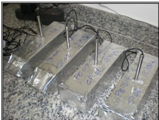
Figura 39 - Sensores introduzidos nos concretos selados com filme plástico e fita de alumínio.
