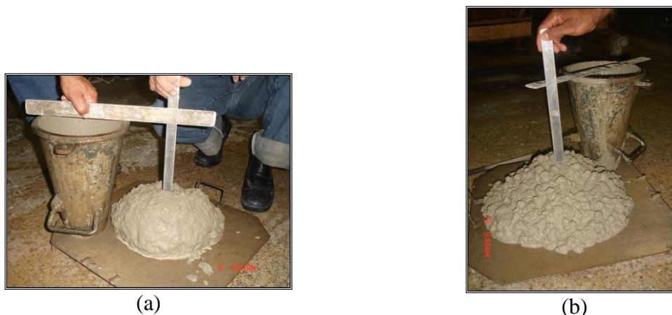
Figura 51 - Aspecto do concreto C80 após abatimento: a) C80_0 e b) C80_2.
