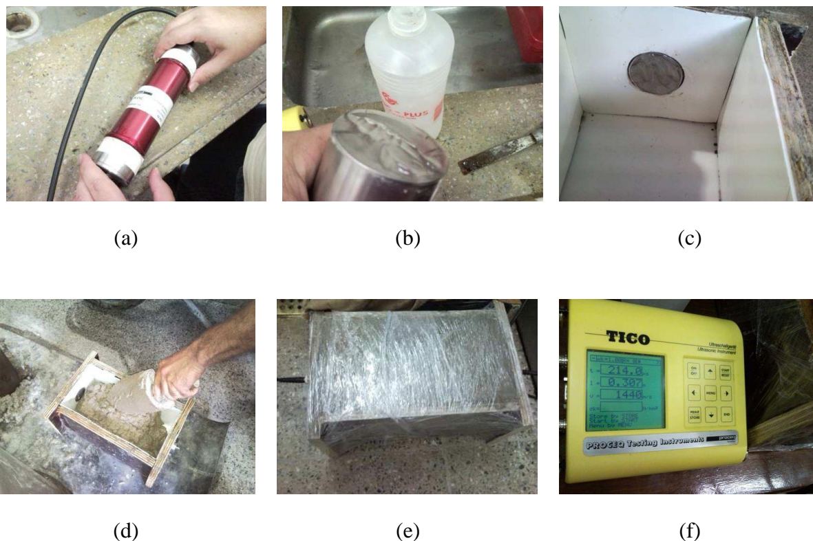
Figura 34 - Procedimento para determinação do patamar de percolação, usando método ultrassônico. (a) calibração do aparelho; (b) gel nos transdutores para garantia do contato com o concreto; (c) detalhe da forma revestida com chapa de poliestireno 2 mm e do transdutor acoplado à forma; (d) moldagem do corpo de prova; (e) corpo de prova moldado e selado com filme plástico e (f) equipamento de ultrassom utilizado.
