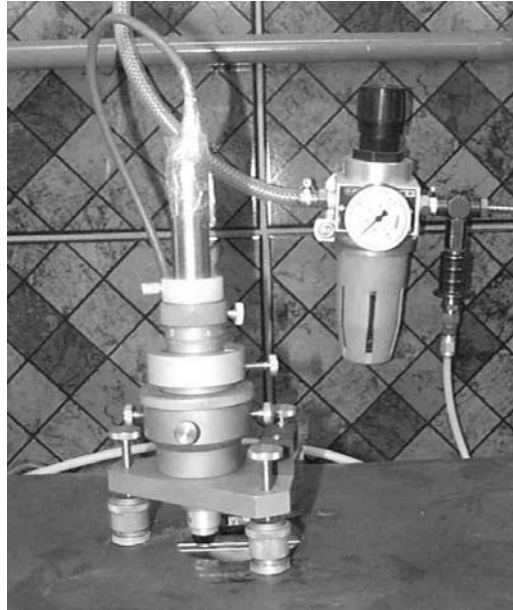
Figura 3.3- Milling Guide RS 200 da MicroMeasurements utilizado para a usinagem dos furos.
