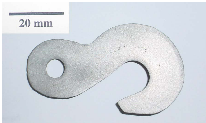
Figura 4.5- Macrografia da seção transversal do gancho. Ataque: Nital 10%.
