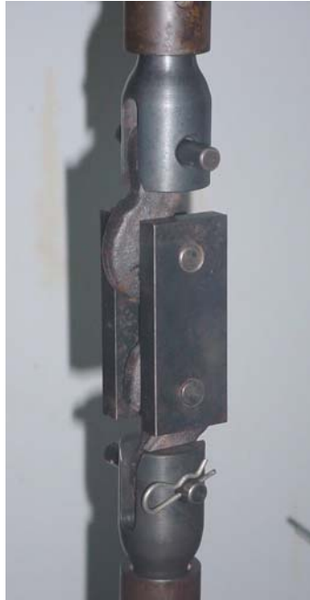
Figura 3.5- Dispositivo desenvolvido para o ensaio simultâneo de 2 ganchos.
