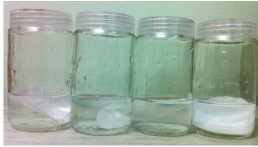
Figura 9: Experimento estático de adsorção com membranas comerciais.
