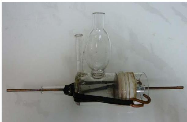
**Figura 3.1:** Célula ôhmica utilizada para determinar a condutividade elétrica do suco de mirtilo.
