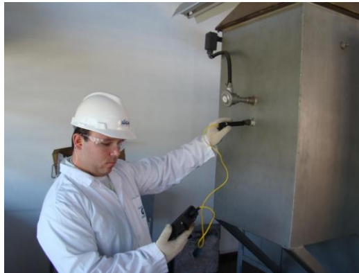
Figura 7. Medida da temperatura dos gases de combustão através de um pirômetro de contato.
