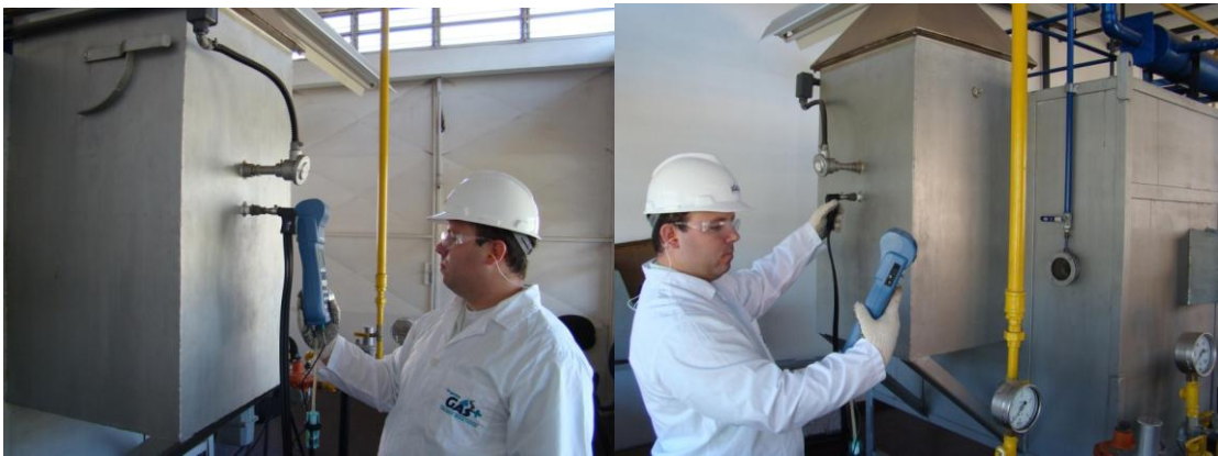
Figura 9. Medição através do analisador de gases.
