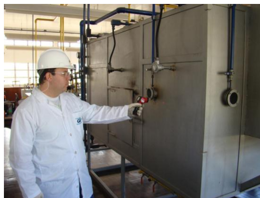
Figura 8. Medida da temperatura de parede através de pirômetro de radiação.
