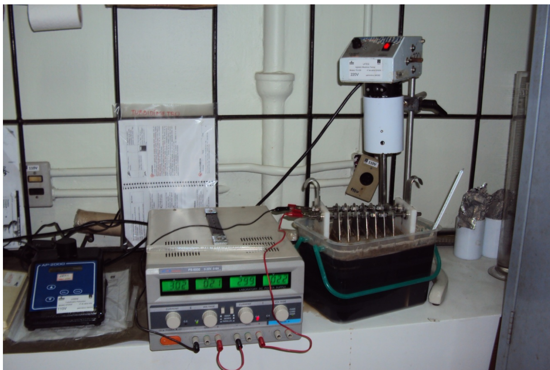
Figura 3.5: fotografia do sistema montado para a realização da eletrólise.
