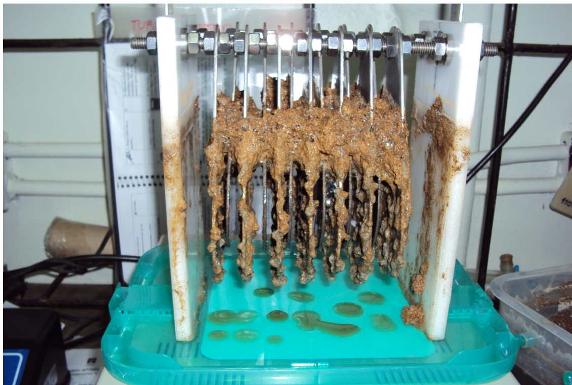
Figura 4.3: fotografia do conjunto de eletrodos após 180 minutos de eletrólise.
