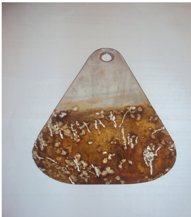
Figura 4.5: fotografia do eletrodo de aço inox após as eletrólises.
