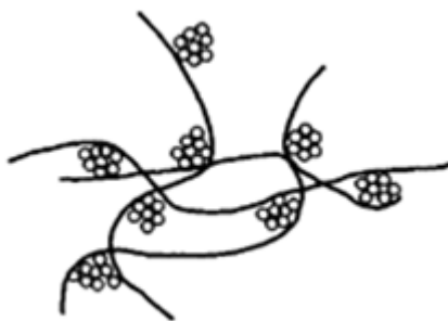
Figura 8. Representação do floco formado pela ação de um polieletrólito.
