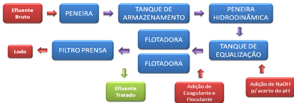
Figura 13. Fluxograma do processo de tratamento de efluentes da Fiateci
