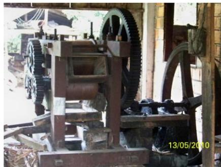
**Figura 6:** Foto de engenho movido a motor
