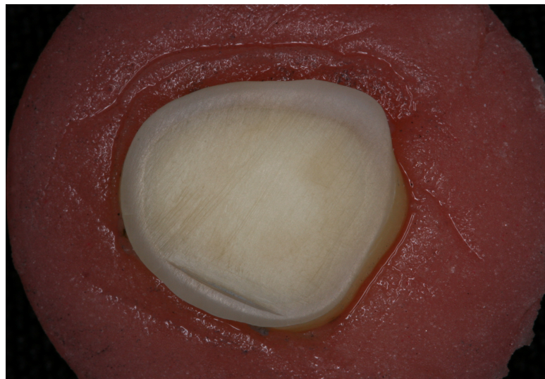
Figura 2- Exposição de dentina média de forma plana para posterior cimentação do bloco cerâmico.
