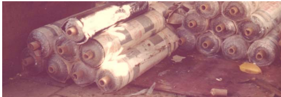
Figura 16: mantas asfálticas para impermeabilização.
