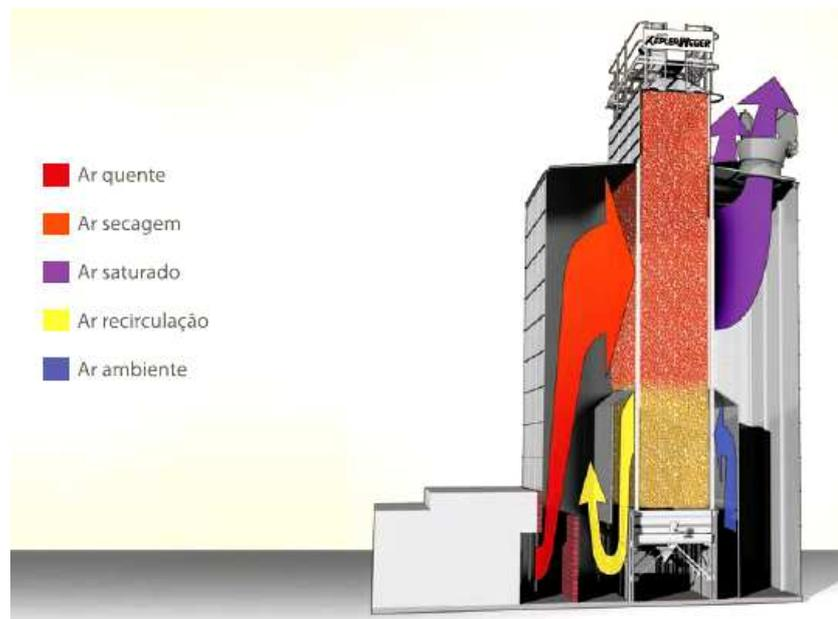
Figura 2.16 Recirculação do ar em secador de fluxo contínuo.
