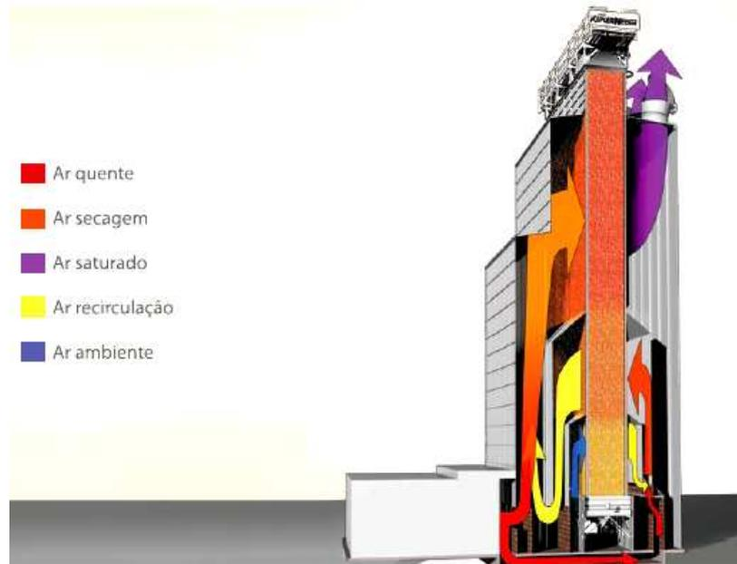
Figura 2.17 Dupla recirculação do ar em secador de fluxo contínuo.
