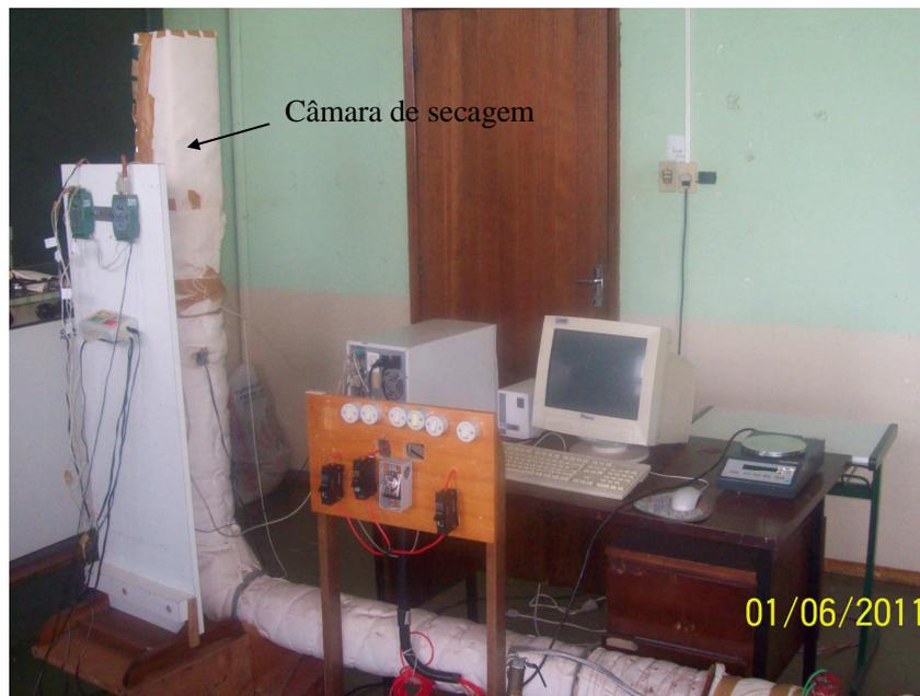
Figura 5.5 Equipamento experimental de secagem em camada espessa.
