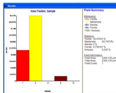
Figura 97 – (a) Foto da região analisada, onde evidenciamos a presença de três fases. (b) Gráfico gerado pelo software quantificando as fases presentes. Neste ponto tivemos a formação de martensita, perlita e ferrita.
