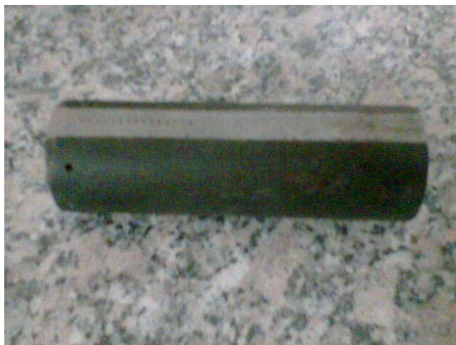
Figura 31 - Corpo de prova usinado para ensaio de dureza.
