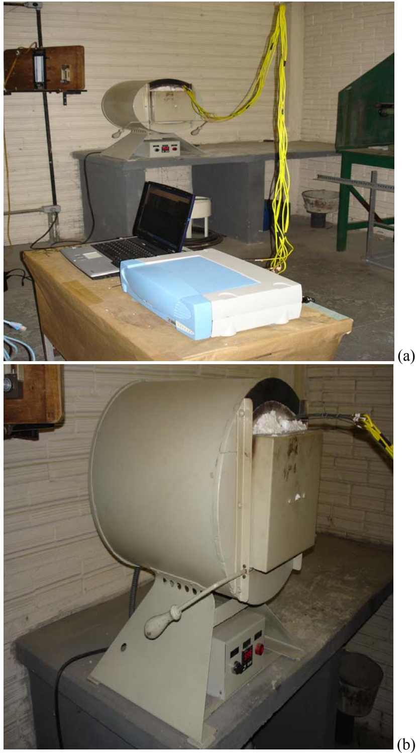
Figura 26 - Em (a), o sistema de aquisição de dados utilizado para a obtenção das curvas de resfriamento experimentais juntamente com o forno resistivo. Em (b), o forno com mantas refratárias no ponto de passagem dos termopares.
