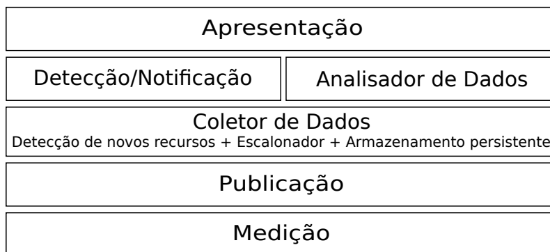
Figura 3.5: Camadas da arquitetura da ferramenta de monitoramento GridICE
