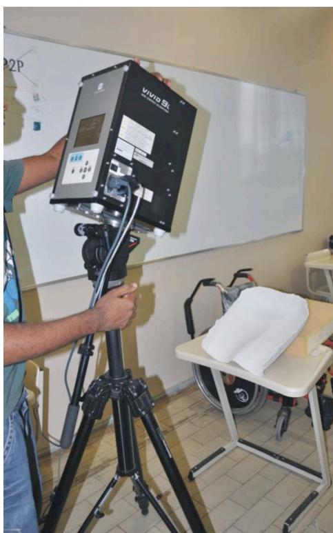
Fig. 29: Molde de gesso sendo digitalizado pelo equipamento de digitalização tridimensional a laser Minolta Vivid 9i.
