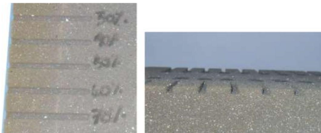
Fig. 43: Espuma D50 usinada com a ferramenta A, a 24.000 RPM, de 1.200, 1.600, 2.000, 2.400 e 2.800 mm/min (30% a 70%).
