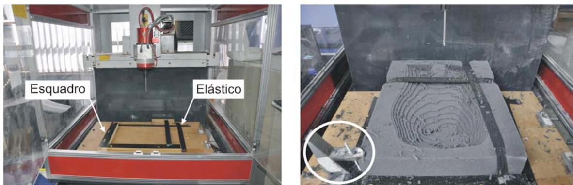
Fig. 33: Adaptações feitas na área de usinagem. (A) Esquadro posicionado com as fitas de contenção. (B) Apoio para evitar deslocamentos verticais.
