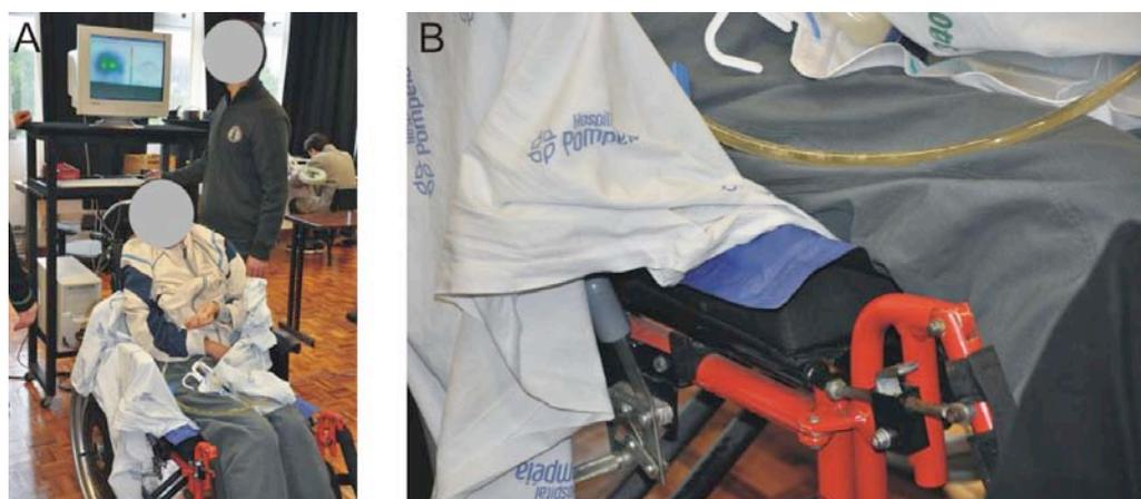
Fig. 34: Análise da distribuição de pressão. (A) Usuário posicionado na cadeira e medição feita através de *software* dedicado. (B) Detalhe do posicionamento do tapete medidor de pressões.
