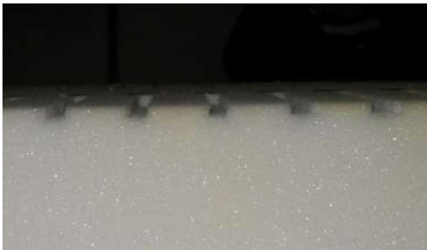
Fig 36: Corte na espuma D45 com rotação de 18.000 RPM e avanços entre 1.600 e 3.200 mm/min.
