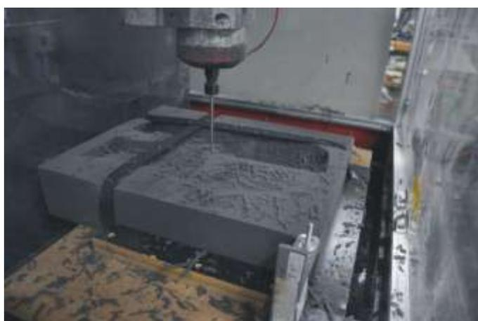
Fig. 52: Assento sendo usinado em quatro partes (usinagem do terceiro quadrante).
