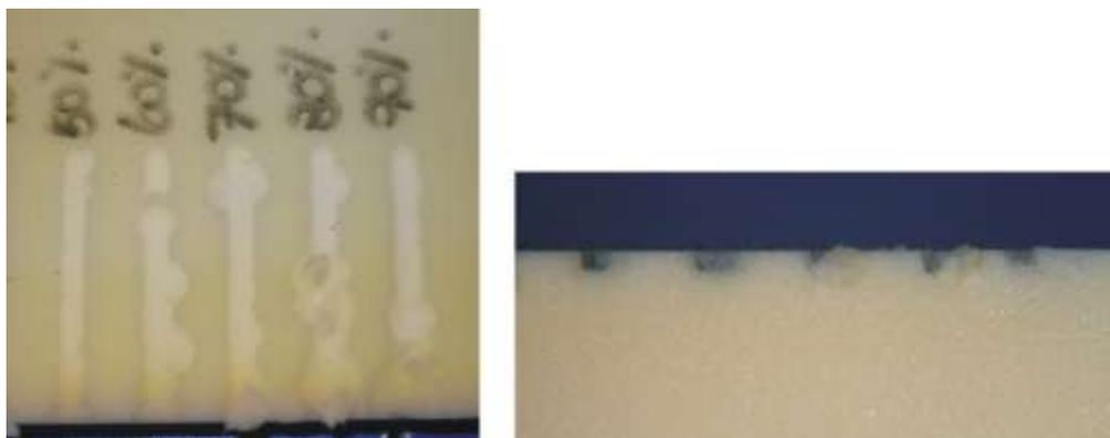
Fig. 39: Dificuldade de usinagem na espuma D20 a 1.800 RPM e 2.000, 2.400, 2.800, 3.200 e 3.600 mm/min (50% a 90%) com ferramenta com duas lâminas de corte.
